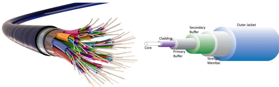
**Consiste em uma Casca e um Núcleo (de vidro) para transmissão de luz.** Possui capacidade de transmissão virtualmente infinita, é imune a interferências eletromagnéticas e consegue ligar distâncias maiores sem a necessidade de repetidores. Como desvantagens, podemos dizer que é incapaz de fazer curvas acentuadas, além de ter um custo de instalação e manutenção muito alto em relação ao par trançado. *Entendido?* Há dois tipos de fibra: **Monomodo e Multimodo.**
