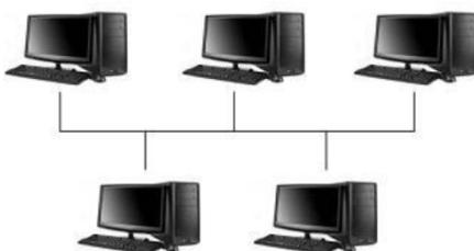
A figura acima mostra uma topologia típica de uma rede industrial de comunicação onde todos os dispositivos compartilham o mesmo meio físico de comunicação. O controle pode ser centralizado ou distribuído. Além de possuir alto poder de expansão, nós com falha não prejudicam necessariamente os demais. Qual a topologia descrita?
