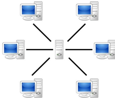
Observem a imagem acima: **as máquinas estão todas ligadas a uma única máquina, hierarquicamente diferente**. Ao contrário do que ocorre nas redes par-a-par, os computadores que funcionam como clientes não fornecem recursos e serviços aos outros computadores da rede. Existem diversos tipos de servidores, como por exemplo: servidor de impressão, servidor de e-mails, servidor de arquivos, servidor de comunicação, servidor de banco de dados, etc.
