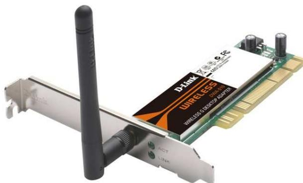
**Galera, essa é a famosa Placa de Rede<sup>5</sup>!** Se vocês olharem na parte de trás do gabinete de um computador, vocês a verão (provavelmente com o cabo azul de par trançado conectado a ela). Ela é o recurso de hardware mínimo que deverá estar instalado no computador para permitir uma comunicação bidirecional – transmissão e recebimento de dados – com os demais elementos da rede. Agora vejam que coisa interessante...
