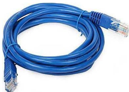
**Consiste de quatro pares de fios trançados blindados ou não, e envolto de um revestimento externo flexível.** Eles são trançados para diminuir a interferência eletromagnética externa e interna – quanto mais giros, maior a atenuação. Este é o cabo mais utilizado atualmente por ser o mais barato de todos e ser bastante flexível. Esse cabo cobre distâncias menores que o cabo coaxial e utiliza um conector chamado RJ-45 (**Memorizem!**).
