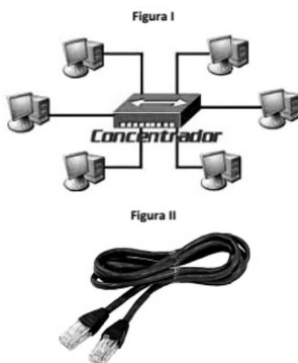
A conexão é feita por meio desse cabo, com um conector específico e utiliza a um link ponto a ponto entre o computador e a porta do concentrador.
