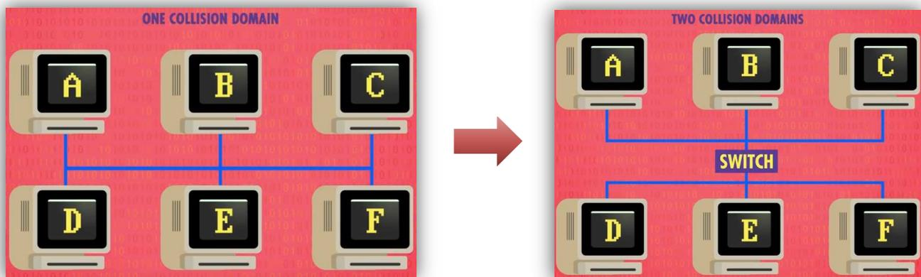
**Para tal, podemos utilizar um dispositivo chamado Switch – visto anteriormente. Ele segmentará nossa rede em duas partes e será posicionado entre elas.** Dessa forma, ele só passa dados para o outro domínio de colisão se a mensagem for destinada a algum computador presente nesse domínio de colisão. *Como ele faz isso, professor?* Ele guarda uma lista de Endereços MAC dos computadores de cada rede.
