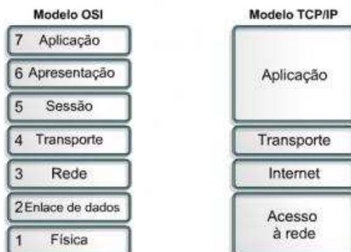
A camada de Aplicação, no modelo TCP/IP, “absorve” as camadas de Sessão e Apresentação do modelo OSI.
