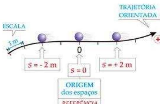
Nela, podemos afirmar que o corpo ao se mover da posição  $S_0 = +2\text{m}$  para a posição  $S_f = -2\text{m}$ , percorreu uma distância efetiva de 4m.
