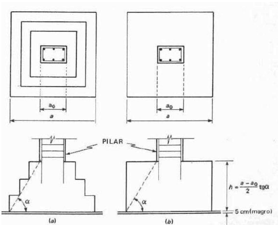
Não confundir blocos de fundação com blocos de coroamento ou de capeamento, os quais são construídos sobre estacas ou tubulões, e são armados de modo a transmitir a carga dos pilares para as estacas ou os tubulões.
