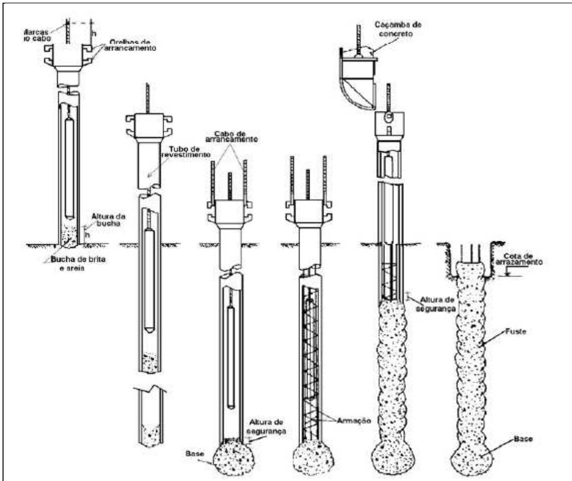
25) (27-A – CGU/2008 – ESAF) A execução da estaca franki é realizada pela cravação dinâmica de um tubo com bucha composta de areia e pedra.
