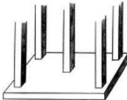
**9) (21-5 – PF/2002) Na possibilidade de utilização de fundação direta em solo compressível, a fundação em radier pode ser mais vantajosa que a em sapatas individuais, por minimizar os efeitos de recalques diferenciais entre elementos de fundação.**
