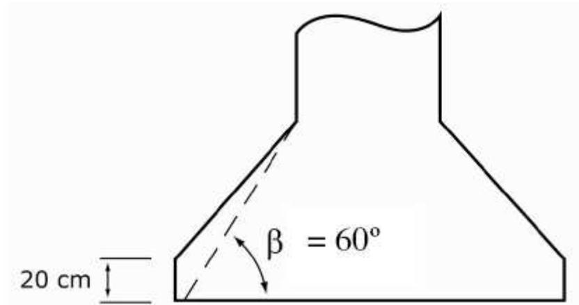
Nos tubulões revestidos despreza-se a força de atrito entre o fuste e o solo, sendo a carga do pilar transmitida ao solo integralmente pela base.
