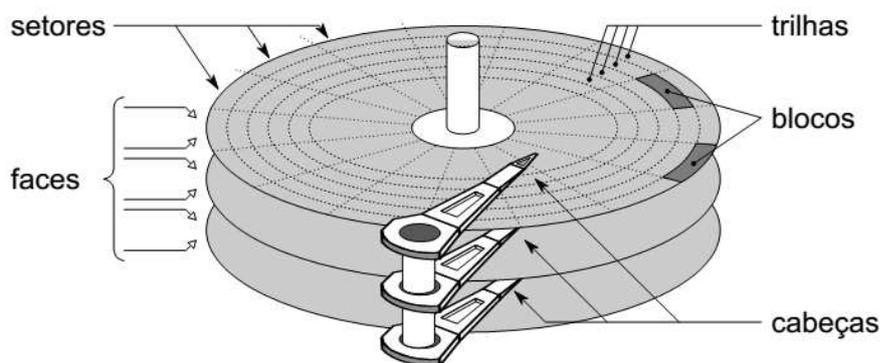
Cada face é dividida logicamente em trilhas e setores; a interseção de uma trilha e um setor define um **bloco**, que é a unidade básica de armazenamento e transferência de dados no disco.
