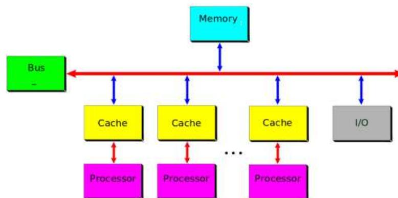
Uma arquitetura multiprocessada é a de processadores **Uniform Memory Access** (UMA), que utiliza um único barramento para comunicação entre os processadores e a memória RAM.
