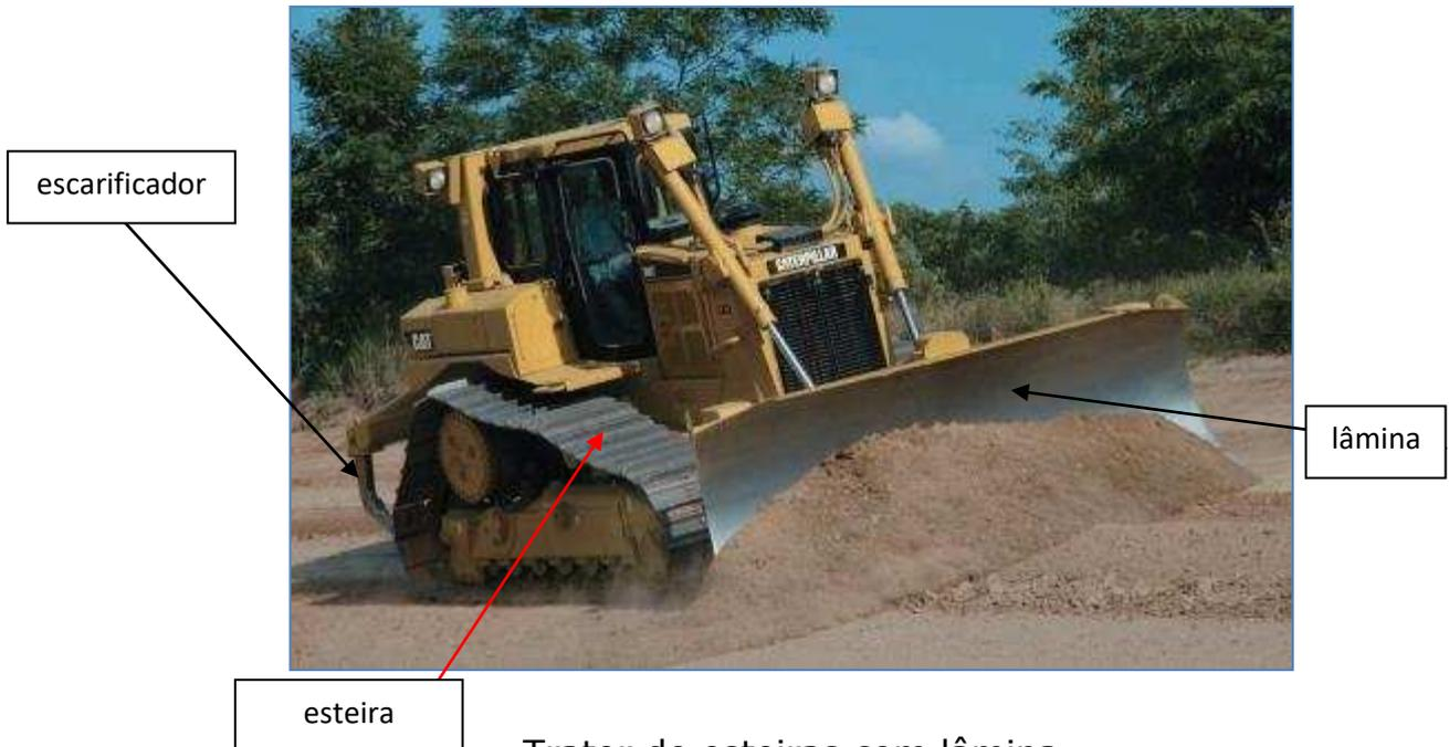
Os serviços de escavação realizados por tratores com lâmina são realizados em terrenos com grande dificuldade de suporte e aderência, sendo, portanto, indicada a utilização de tratores de esteiras, e não pneus, para esses serviços.
