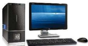
**Desktop** – Este é o computador “clássico”. Monitor, gabinete e teclado, todos bem separados. Precisa estar ligado a uma fonte de energia o tempo inteiro para funcionar. Em nosso estudo de HW&SW, estaremos nos baseando nos desktops, embora todos os componentes de seu interior também existam nos demais tipos de computadores.
