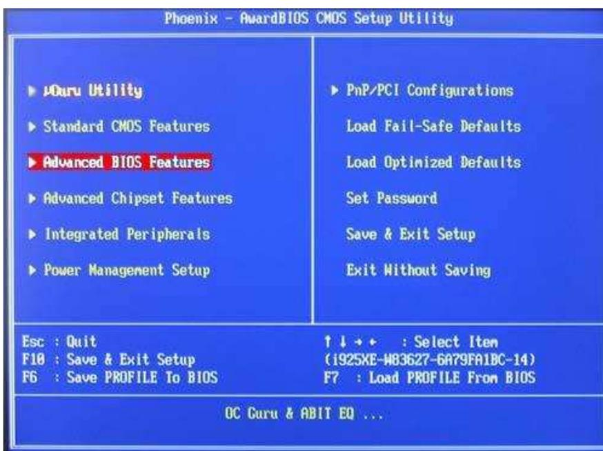
\*Você já configurou a BIOS do seu computador? Pressionando DEL, F2 ou F8 (a depender do fabricante), é possível verificar elementos básicos, como a sequência de BOOT da máquina, ou até mesmo a velocidade que o processador trabalha.
