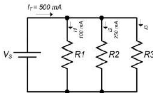
Figura 1: Circuito elétrico.
