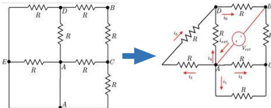
Com esse novo desenho fica mais fácil identificar quais resistores estão em série e em paralelo. A resistência equivalente entre os nós A e D, será:
