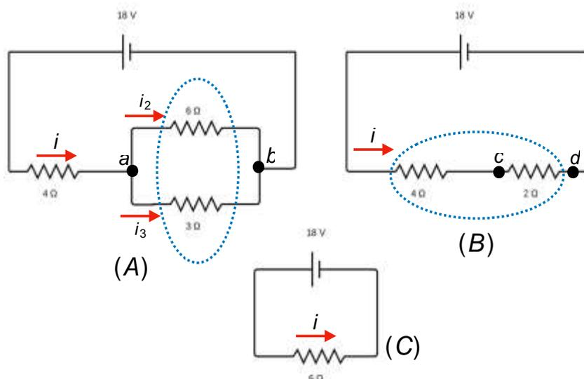
Primeiro passo: Precisamos determinar a resistência equivalente do circuito, pois dessa forma poderemos encontrar a corrente total  $i$ . Podemos imaginar que a fonte de tensão “sente” apenas a resistência equivalente, ou seja, a configuração do circuito é uma espécie de “caixa preta”, entendeu?
