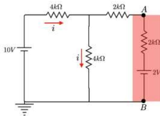
Para determinar a corrente  $i$ , vamos montar a equação da malha.
