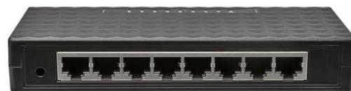
O Hub é considerado um dispositivo “burro” por trabalhar apenas com *broadcast*. *Como assim, professor?* Ao receber dados, **ele os distribui para todas as outras máquinas – ele não é capaz de transmitir dados somente para uma máquina específica**, implicando que apenas uma máquina transmita de cada vez para evitar colisões. A transmissão *broadcast* faz com que uma rede com Hub possua uma topologia física de Estrela e uma topologia lógica de Barramento.
