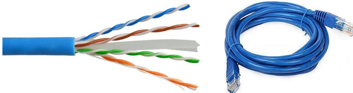
**Consiste de quatro pares de fios trançados blindados ou não, e envolto de um revestimento externo flexível.** Eles são trançados para diminuir a interferência eletromagnética externa e interna – quanto mais giros, maior a atenuação. Este é o cabo mais utilizado atualmente por ser o mais barato de todos e ser bastante flexível. Esse cabo cobre distâncias menores que o cabo coaxial e utiliza um conector chamado RJ-45 (**Memorizem!**).
