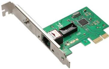
**Galera, essa é a famosa Placa de Rede!** Se vocês olharem na parte de trás do gabinete de um computador, vocês a verão (provavelmente com o cabo azul de par trançado conectado a ela). Ela é o recurso de hardware mínimo que deverá estar instalado no computador para permitir uma comunicação bidirecional – transmissão e recebimento de dados – com os demais elementos da rede. Agora vejam só...
