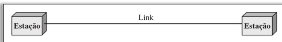
Quando mudamos os canais de televisão por meio da utilização de um controle remoto infravermelho, nós estamos estabelecendo uma conexão ponto-a-ponto entre o controle remoto e o sistema de controle de TV. *Bacana?* **Já uma conexão ponto-multiponto é uma conexão na qual mais de dois dispositivos compartilham um único link.** E em ambiente multiponto, a capacidade do canal de comunicação é compartilhada, seja de força espacial ou seja de forma temporal.
