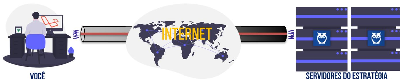
Entrando um pouco mais a fundo: para que haja maior segurança na camada de rede, as redes privadas virtuais utilizam técnicas de tunelamento. *Como é, Diego?* **A técnica de tunelamento consiste no encapsulamento de um protocolo dentro de outro, permitindo que um pacote seja enviado com segurança através de uma rede pública como a Internet. Por conta disso, é utilizado para a criação de VPNs.**
