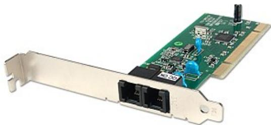
O Modem é um dispositivo eletrônico de entrada/saída de dados que modula um sinal digital em um sinal analógico a ser transmitida por meio de uma linha telefônica e que demodula o sinal analógico e o converte para o sinal digital original. **Hoje em dia, existem basicamente três tipos: Acesso Discado, Modem ADSL e Cable Modem.**
