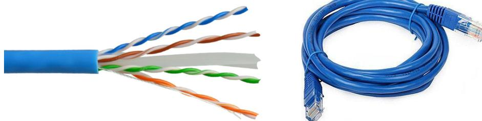
**Consiste em quatro pares de fios trançados blindados ou não, e envolto de um revestimento externo flexível.** Eles são trançados para diminuir a interferência eletromagnética externa e interna – quanto mais giros, maior a atenuação. Este é o cabo mais utilizado atualmente por ser o mais barato de todos e ser bastante flexível. Esse cabo cobre distâncias menores que o cabo coaxial e utiliza um conector chamado RJ-45 (**Memorizem!**).
