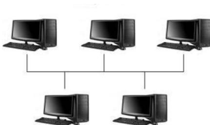
A figura acima mostra uma topologia típica de uma rede industrial de comunicação onde todos os dispositivos compartilham o mesmo meio físico de comunicação. O controle pode ser centralizado ou distribuído. Além de possuir alto poder de expansão, nós com falha não prejudicam necessariamente os demais. Qual a topologia descrita?
