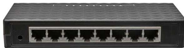
**Um hub ativo é um dispositivo para interligação de computadores que tem o objetivo de concentrar os enlaces e aumentar o alcance de uma rede local por meio da regeneração de sinais.** Pessoal, sinais que transportam dados dentro de uma rede podem trafegar por uma distância fixa. Após essa distância, o sinal começa a se atenuar, colocando em risco a integridade dos dados (isto é, correndo risco de haver perda de dados).
