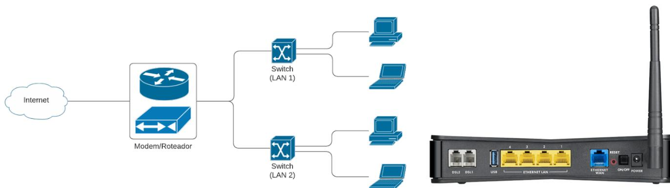
Um roteador pode ser com fio ou sem fio (wireless). Atualmente, a maioria dos roteadores do mercado são sem fio – apesar de permitirem conexão cabeada também. Nós já sabemos que um roteador é capaz de interligar redes diferentes. **No entanto, um roteador wireless é um dispositivo mais flexível, podendo trabalhar em outros três modos diferentes: Hotspot, Access Point ou Repetidor de Sinal.** Vamos falar sobre cada um deles...
