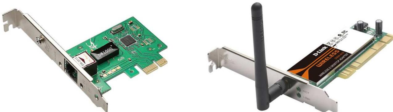
**Essas são as famosas Placas de Rede – também chamada de Placas NIC.** Na imagem apresentada à esquerda, temos uma placa de rede cabeada e, na imagem apresentada à direita, temos uma placa de rede não cabeada (*wireless*). Essas placas podem ser instaladas internamente em um computador (forma mais comum) ou podem ser dispositivos externos, como pequenos adaptadores USB.
