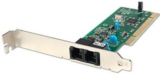
O Modem é um dispositivo eletrônico de entrada/saída de dados que modula um sinal digital em um sinal analógico a ser transmitida por meio de uma linha telefônica e que demodula o sinal analógico e o converte para o sinal digital original. **Hoje em dia, existem basicamente três tipos: Acesso Discado, Modem ADSL e Cable Modem.**
