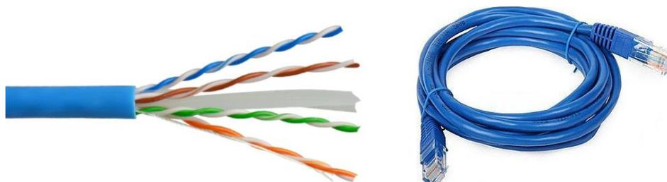
**Consiste de quatro pares de fios trançados blindados ou não, e envolto de um revestimento externo flexível.** Eles são trançados para diminuir a interferência eletromagnética externa e interna – quanto mais giros, maior a atenuação. Este é o cabo mais utilizado atualmente por ser o mais barato de todos e ser bastante flexível. Esse cabo cobre distâncias menores que o cabo coaxial e utiliza um conector chamado RJ-45 (**Memorizem!**).
