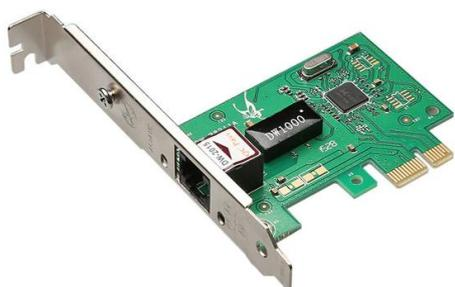
**Galera, essa é a famosa Placa de Rede!** Se vocês olharem na parte de trás do gabinete de um computador, vocês a verão (provavelmente com o cabo azul de par trançado conectado a ela). Esse é o recurso de hardware geralmente instalado no computador para permitir uma comunicação bidirecional – transmissão e recebimento de dados – com os demais elementos da rede. Agora vejam que coisa interessante...
