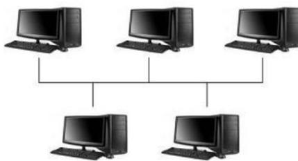
A figura acima mostra uma topologia típica de uma rede industrial de comunicação onde todos os dispositivos compartilham o mesmo meio físico de comunicação. O controle pode ser centralizado ou distribuído. Além de possuir alto poder de expansão, nós com falha não prejudicam necessariamente os demais. Qual a topologia descrita?
