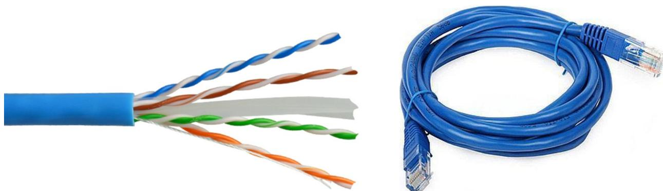
Consiste de quatro pares de fios trançados blindados ou não, e envolto de um revestimento externo flexível. Eles são trançados para diminuir a interferência eletromagnética externa e interna – quanto mais giros, menor a atenuação. Este é o cabo mais utilizado atualmente por ser o mais barato de todos e ser bastante flexível. Esse cabo cobre distâncias menores que o cabo coaxial e utiliza um conector chamado RJ-45 (**Memorizem!**).
