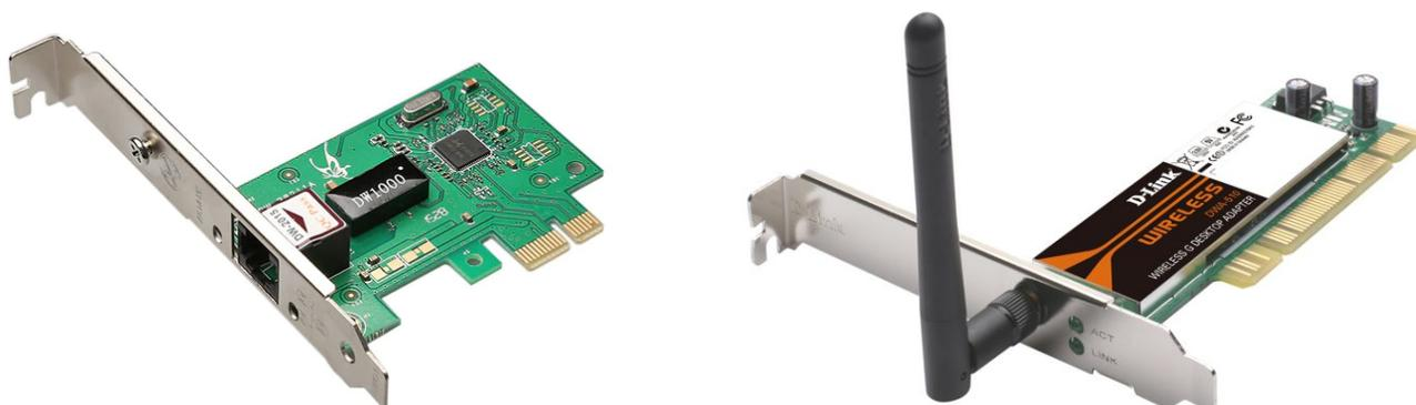
**Galera, essa é a famosa Placa de Rede<sup>4</sup>!** Se vocês olharem na parte de trás do gabinete de um computador, vocês a verão (provavelmente com o cabo azul de par trançado conectado a ela). Ela é o recurso de hardware mínimo que deverá estar instalado no computador para permitir uma comunicação bidirecional – transmissão e recebimento de dados – com os demais elementos da rede. Agora vejam que coisa interessante...
