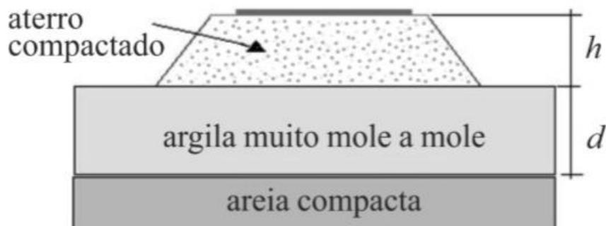
Com base na figura precedente, que apresenta um aterro para pavimento rodoviário construído sobre uma camada de solo mole, saturada, uniforme e homogênea, assinale a opção correta.
