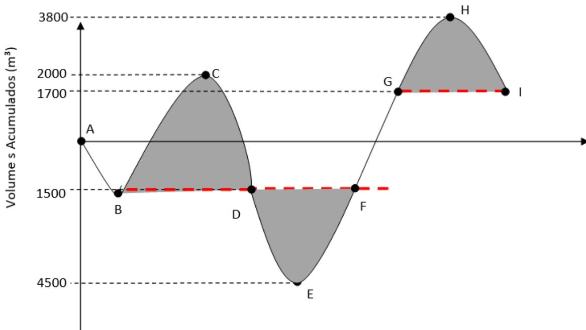
Nesse caso, entre os pontos A e B teremos um volume de aterro sem compensação, isso significa a necessidade de obtermos uma caixa de empréstimo para abastecer esse segmento, com volume na ordem de  $1.500 \text{ m}^3$ .
