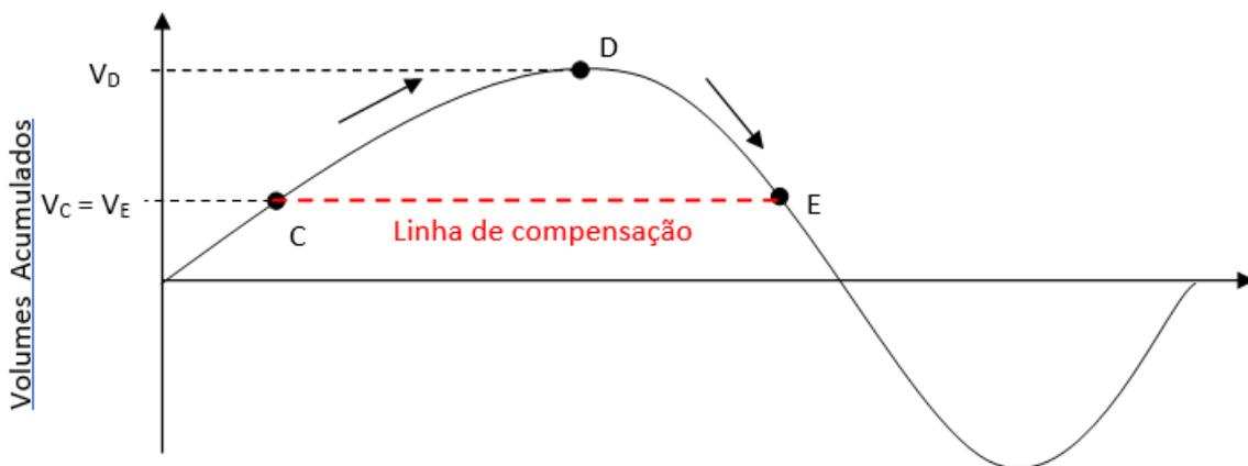
Segundo a figura acima, entre o ponto C e o ponto D tem-se um segmento em corte, cujo volume é ( $V_D - V_C$ ). Entre o ponto D, e o ponto E, tem-se um trecho em aterro, cujo volume é ( $V_D - V_E$ ), que é igual a ( $V_D - V_C$ ). Portanto, entre os pontos C e E têm-se volumes compensando-se longitudinalmente.
