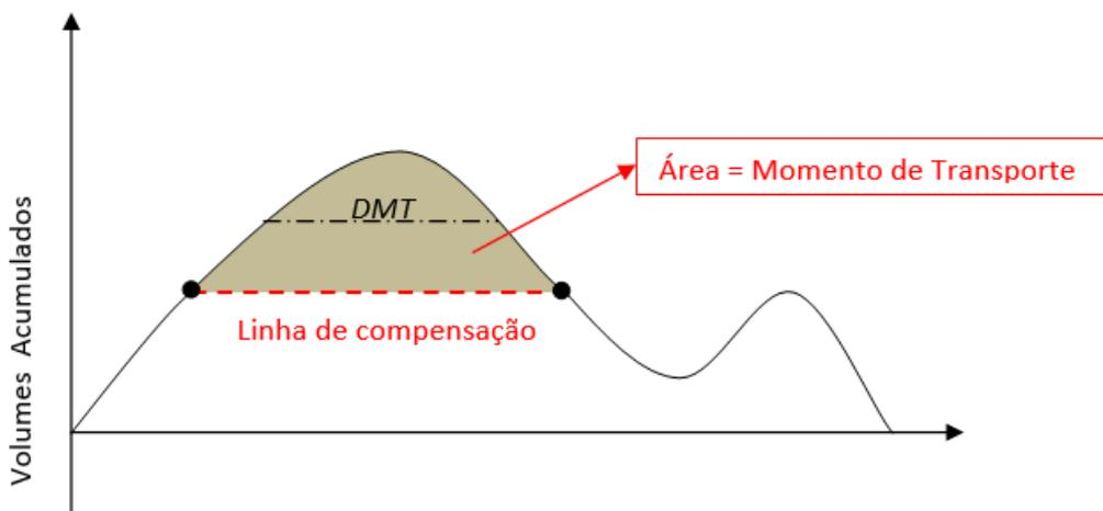
Quando é executado um transporte de solo de um corte para um aterro, as distâncias de transporte se alteram a cada viagem, sendo necessária, portanto, a determinação de uma distância média de transporte, que deverá ser igual à **distância entre os centros de gravidade dos trechos de cortes e aterros compensados**.
