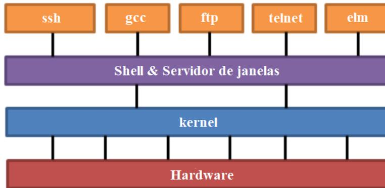
Na figura acima podemos ver cinco aplicativos que utilizam alguma interface (shell ou servidor de janelas), que por sua vez faz a “ligação” com o kernel. E somente o kernel faz a iteração com o hardware (disco, teclado, monitor de vídeo etc.).
