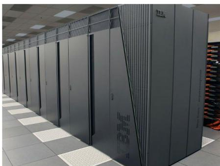
**I. Mainframe:** é um computador de grande porte, que possui alta capacidade de processamento e armazenamento de dados. O termo mainframe era utilizado para se referir ao gabinete principal que alojava a unidade central de processamento nos primeiros computadores.
