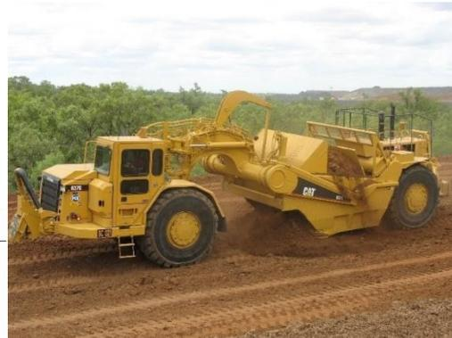
As operações realizadas são as mesmas dos "scraper" rebocados por tratores, porém podendo executar as operações com mais independência e eficiência, dada a melhoria da aderência e esforço de tração.
