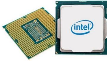
Como o processador realiza milhões de cálculos por segundo, necessitando de energia elétrica para a sua atividade, há uma geração de calor, pois os materiais oferecem resistência à passagem de corrente. Ok, e aí? Aí que os processadores aquecem muito quando estão efetuando tarefas e deve haver alguma forma de refrigeração para evitar danos.
