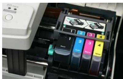
Um ponto importante a destacar é que esse tipo de impressora possui um funcionamento mecânico, possuindo correias, placa lógica e engrenagens. O segredo do funcionamento encontra-se na cabeça de impressão, através dela e de outras tecnologias, microgotículas são depositadas no papel.
