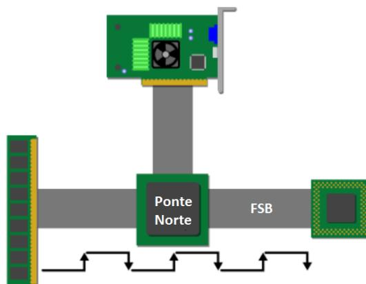
O chip ponte sul é um chip que implementa as capacidades mais com menor desempenho (os mais “lerdos”) da placa-mãe numa arquitetura de chipset ponte norte/ponte sul. Não está diretamente conectado ao processador, havendo uma ligação da ponte norte à ponte sul. Na figura abaixo podemos ver a arquitetura completa ponte norte/ponte sul, com alguns exemplos de barramentos tipicamente utilizados:
