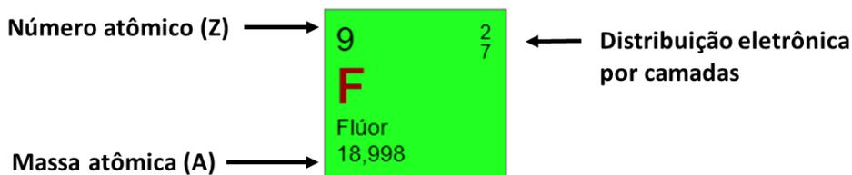
**Fique atento!** Ao ser informado fora da tabela periódica, a massa atômica (A) é apresentada, em geral, na parte superior e o número atômico (Z), na parte inferior, conforme ilustrado abaixo também para o Flúor. Para não confundir, lembre-se que, a exceção do hidrogênio em que  $A = Z$ , a massa atômica (A) será sempre maior que o número atômico (Z).
