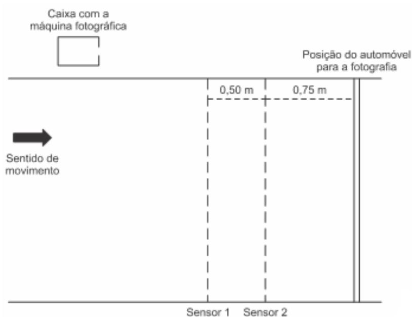
**34.1.** No caso de um automóvel que trafega na velocidade máxima permitida, o tempo, em milissegundos, medido pelo dispositivo, é superior a 20 milissegundos.
