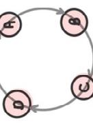
↳ CADA DISPOSITIVO TEM UMA CONEXÃO PONTO A PONTO COM DOIS DISPOSITIVOS LADO A LADO.
