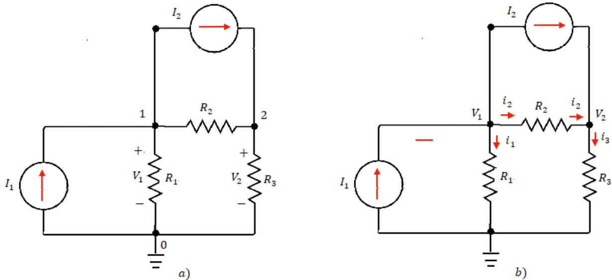
Figura 29-Aplicação do método dos nós (a) circuito original e (b) circuito com os nós definidos.
