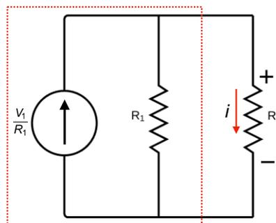
Figura 35- Aplicação do teorema da superposição ao circuito original.
