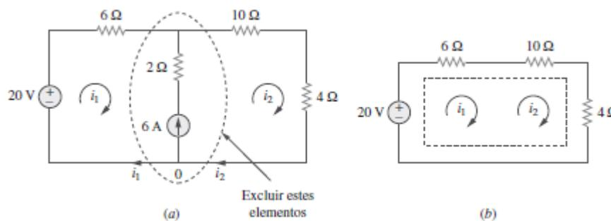
Figura 33- (a) Fonte de corrente em comum a duas malhas. (b) supermalha formada. Alexander e Sadiku (2013).
