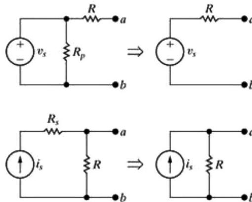
Figura 37-Efeito de uma resistência sobre o circuito equivalente.
