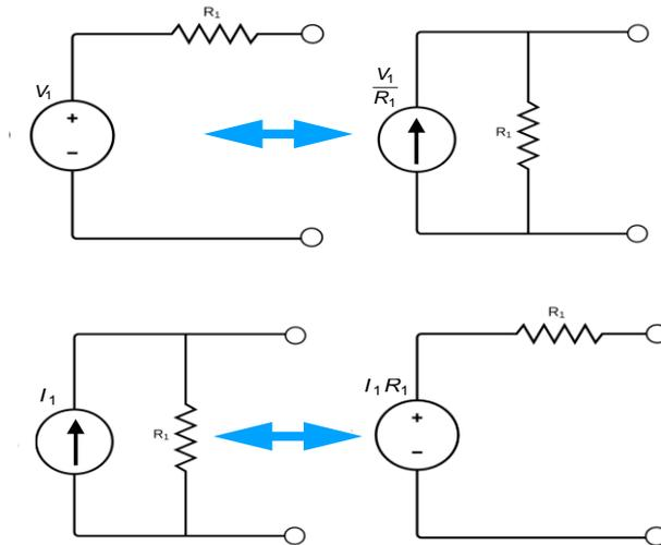
Figura 36-Substituição de fontes.
