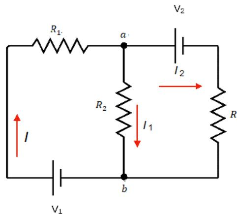
Figura 22-Circuito em que os conceitos de ligação em série e paralelo não são suficientes para a análise.
