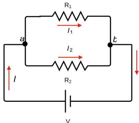
Figura 19-Resistores em paralelo compartilhando os nós a e b.
