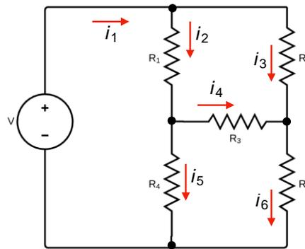
Figura 23- Circuito do tipo ponte.
