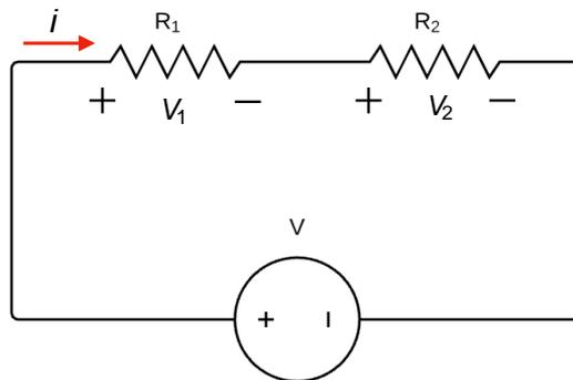
Figura 20-Circuito divisor de tensão.
