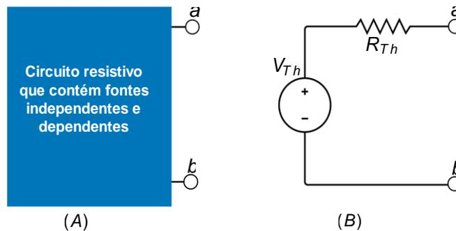
Figura 38-: (A) circuito original; (B) Circuito equivalente de Thévenin.
