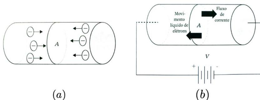
Figura 14- (a) Movimento aleatório dos elétrons, resultando e, uma corte líquida igual a zero; (b) Bateria ligada aos terminais de um condutor de seção transversal A, com corrente líquida diferente de zero.
