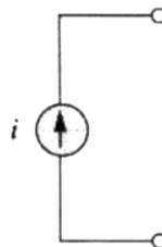
Figura 27-Representação gráfica da uma fonte independente de corrente.
