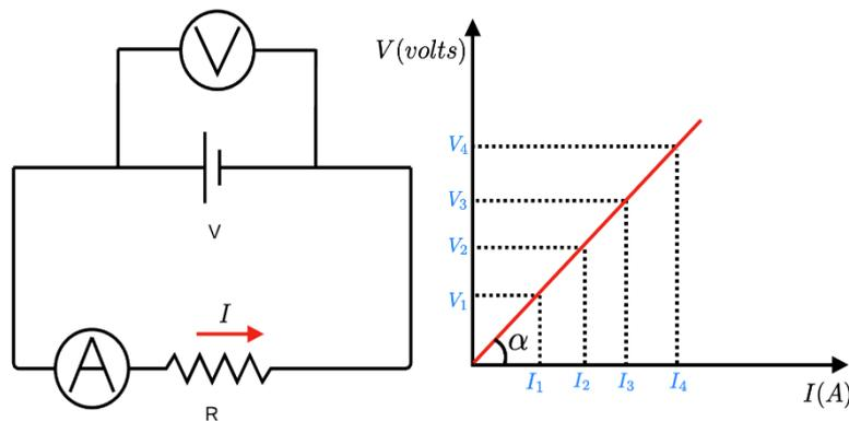
Figura 16-Comportamento de um resistor ôhmico.
