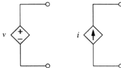
Figura 28-Representação gráfica de fontes dependente de tensão e corrente.
