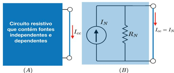
Figura 41-(A) circuito original; (B) Circuito equivalente de Norton.
