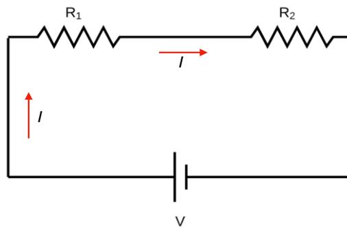
Figura 18-Resistores em série compartilhando a mesma corrente.
