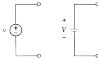
Figura 26-Representação gráfica da uma fonte independente de tensão.
