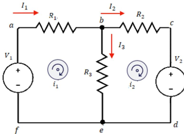
Figura 31-Aplicação do método das malhas.
