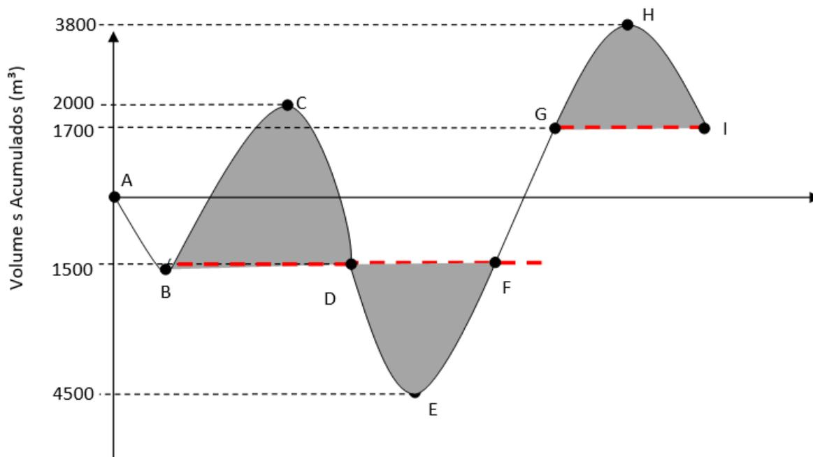
Nesse caso, entre os pontos A e B teremos um volume de aterro sem compensação, isso significa a necessidade de obtermos uma caixa de empréstimo para abastecer esse segmento, com volume na ordem de  $1.500 \text{ m}^3$ .
