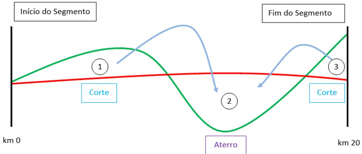
A linha em verde retrata o perfil vertical do terreno natural, no segmento onde a rodovia deverá ser construída. Já a linha em vermelho retrata o perfil vertical projetado da rodovia. Percebam que para se chegar ao alinhamento adequado, deverá haver uma considerável movimentação de terra no segmento a ser construído.
