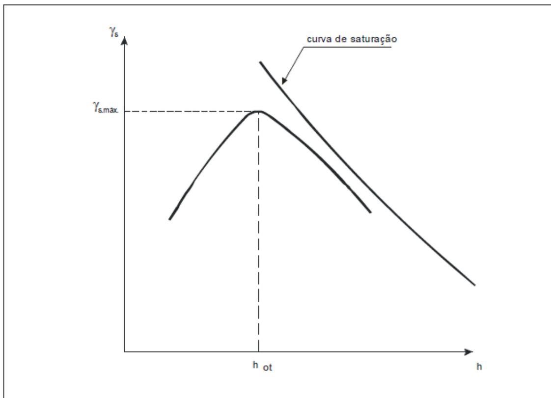
A partir deste ensaio, obtém-se a umidade ótima. Aplicando-se à camada de solo energia de compactação compatível com a aplicada no ensaio, com a umidade ótima, obtém-se o peso específico aparente seco máximo para esta energia.
