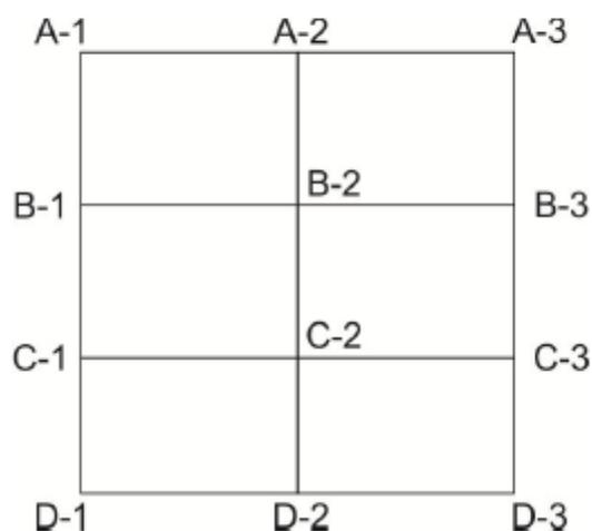
**Cotas em metros obtidas por nivelamento após quadriculação de 10 em 10 metros do terreno**
