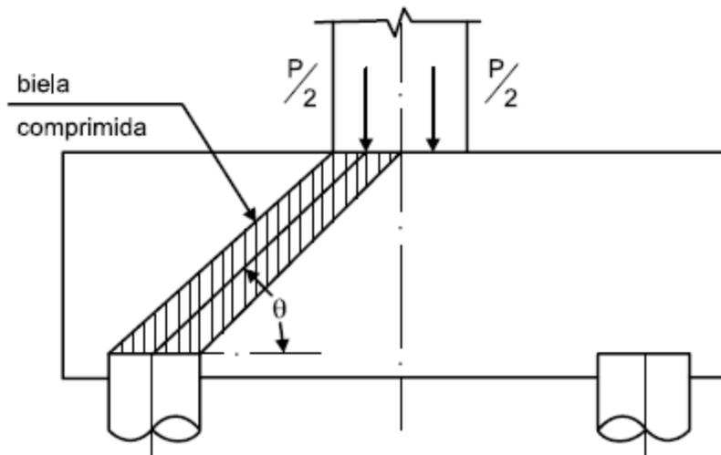
Uma das características do comportamento estrutural desses blocos é que a força transmitida do pilar para as estacas se faz essencialmente por bielas de compressão. Se o ângulo de inclinação das bielas for 30°, a força de compressão resultante em cada biela é
