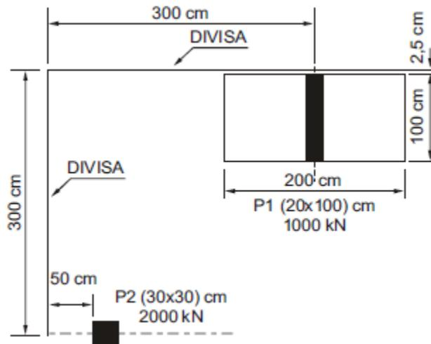
No dimensionamento da fundação direta para o pilar P2 de dimensões 30 cm × 30 cm, com carga de 2000 kN, a sapata mais indicada, distanciada de 2,5 cm da divisa, é
