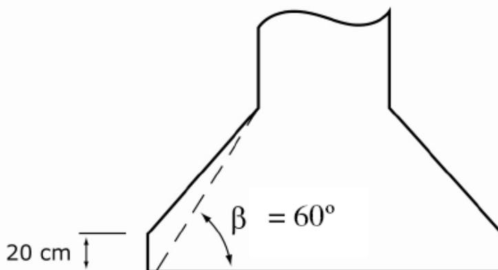
Na utilização do Método Estático para a determinação da carga admissível ou da força resistente de cálculo de tubulões, quando o atrito lateral for considerado, deve ser desprezado um comprimento de fuste igual ao diâmetro da base, imediatamente acima do início do alargamento.
