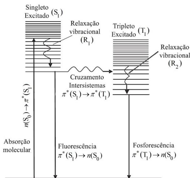
Transições eletrônicas radioativas e não radioativas que explicam os fenômenos fluorescência e fosforescência<sup>4</sup>
