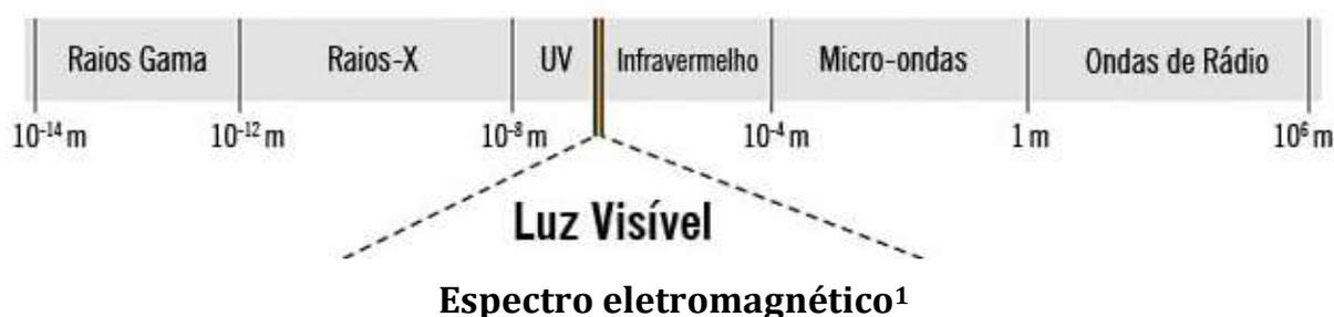
As ondas eletromagnéticas conseguem se propagar no **vácuo** a uma **velocidade de  $3 \cdot 10^8 \text{m/s}$**  (essa velocidade é idêntica para as diferentes faixas de onda eletromagnética). Em meios materiais como a água, a velocidade de propagação é um pouco menor.
