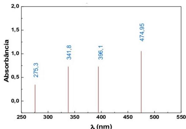
**Espectro de absorção atômica:** formado por linhas finas (raias) devido às transições eletrônicas entre diferentes subníveis energéticos (orbitais)
