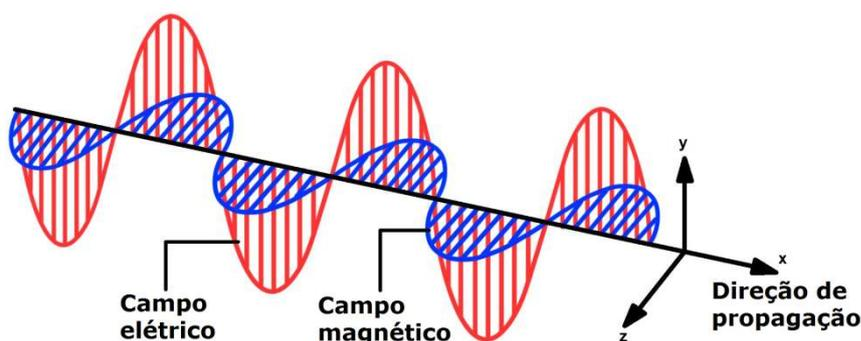
No estudo da espectroscopia, vamos considerar apenas o **campo elétrico** da **radiação eletromagnética**. Será suficiente para discutirmos os principais fenômenos espectroscópicos de interesse da química: absorção, emissão, transmissão, reflexão, refração.
