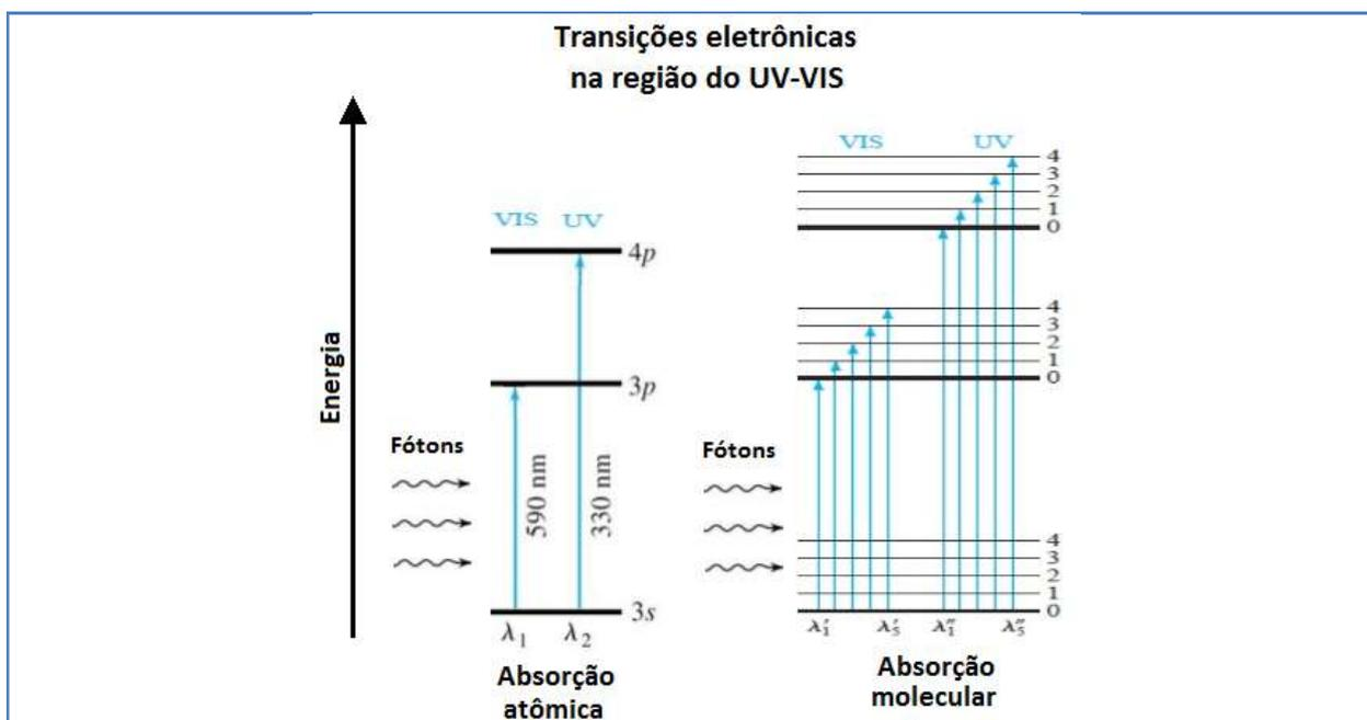
O ganho energético de uma molécula poderá ser convertido em 3 tipos de transições. Devido a todas as possibilidades de transições (eletrônicas, vibracionais e rotacionais) das moléculas, a energia total ( $E$ ) de uma molécula é:
