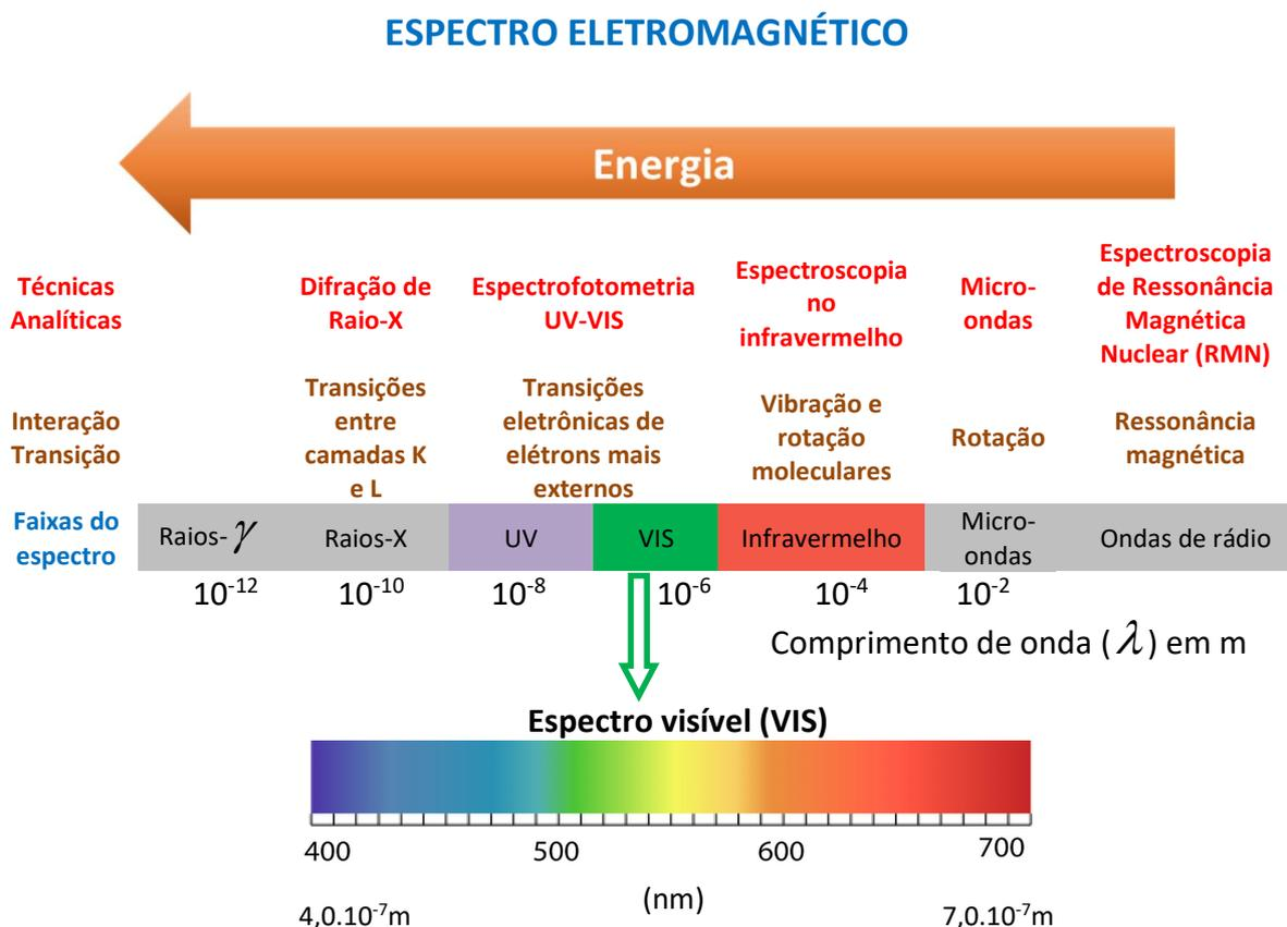
Além disso, a existência das diferentes formas de interação entre a luz e a matéria viabilizou o desenvolvimento de **diferentes técnicas analíticas** (listadas no esquema acima) e de equipamentos utilizados em variadas análises químicas.
