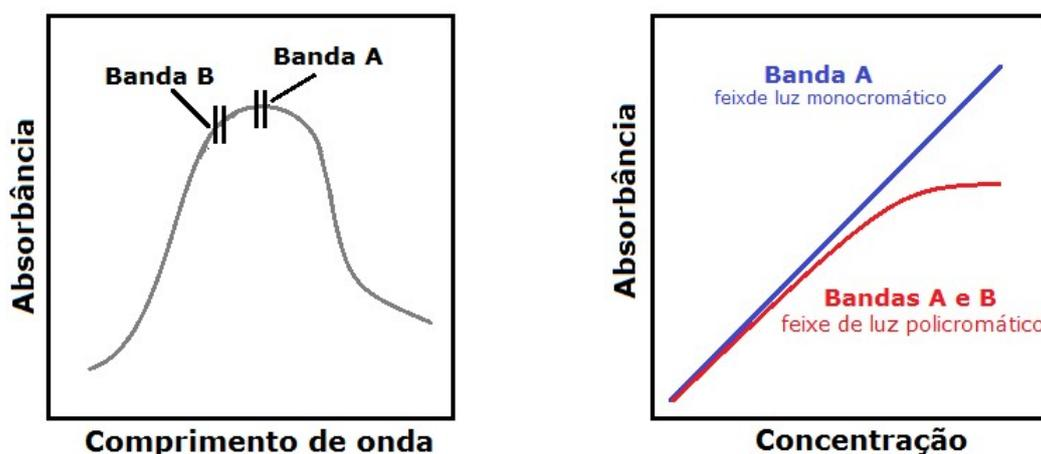
**Luz espúria:** é a radiação fora do comprimento de onda escolhido para análise. Essa radiação indesejada é oriunda de reflexões dos componentes ópticos do equipamento (redes de difração, lentes, espelhos, filtros ou janelas). Se a luz espúria, que é um interferente, estiver presente, então
