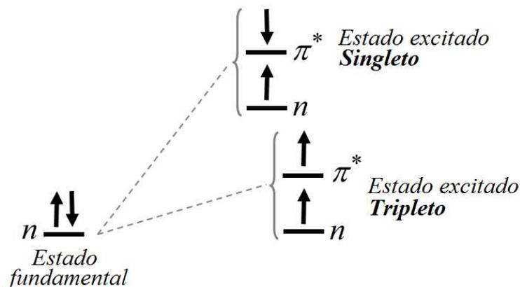
Representação esquemática dos estados excitados singleto e tripleto associados à transição do tipo  $n \rightarrow \pi^*$
