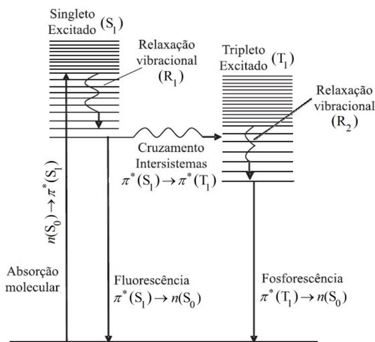
**Transições eletrônicas radioativas e não radioativas que explicam os fenômenos fluorescência e fosforescência<sup>3</sup>**
