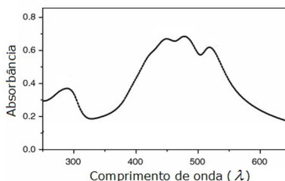
**Espectro de absorção de uma molécula:** formado pela sobreposição de várias bandas de absorção associadas a diferentes transições eletrônicas
