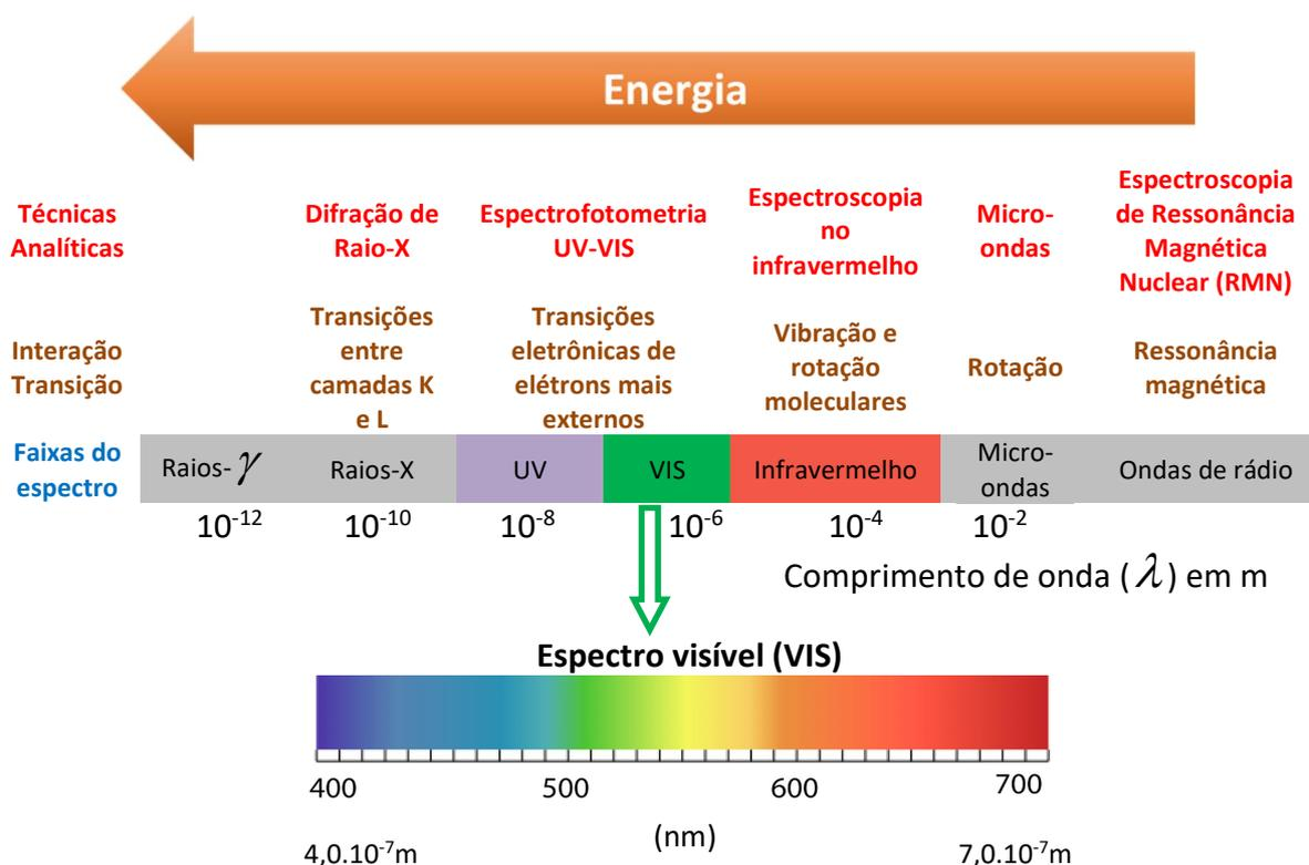
Além disso, a existência das diferentes formas de interação entre a luz e a matéria viabilizou o desenvolvimento de **diferentes técnicas analíticas** (listadas no esquema acima) e de equipamentos utilizados em variadas análises químicas.
