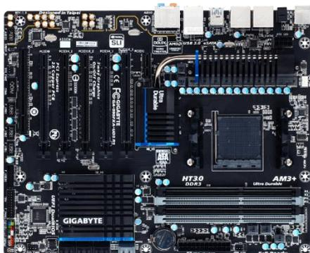
É a placa principal, formada por um conjunto de circuitos integrados onde são encaixados os outros componentes. Ela recebe o processador, as memórias, os conectores de teclado, mouse e impressora, e muito outros dispositivos.
