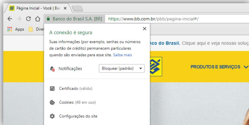
**Basicamente ele é uma implementação do Protocolo HTTP sobre uma camada adicional de segurança que utiliza um outro protocolo chamado SSL/TLS<sup>5</sup>.** Dessa forma, é possível que os dados sejam transmitidos por meio de uma conexão criptografada e que se verifique a autenticidade do Servidor Web e do Cliente Web por meio de
