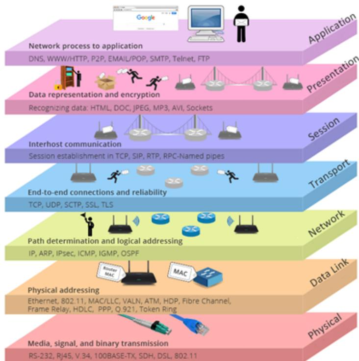
**A partir daí, ficou fácil!** Se for em uma rede cabeada, os bits passam da placa de rede do seu computador para o cabo azul, que passa para o seu roteador, que passa para o provedor de internet, que passa para o seu provedor de e-mail, que passa para o provedor de e-mail do seu amigo que passa para o roteador dele, que passa para o cabo azul dele, que passa para a placa de rede dele...
