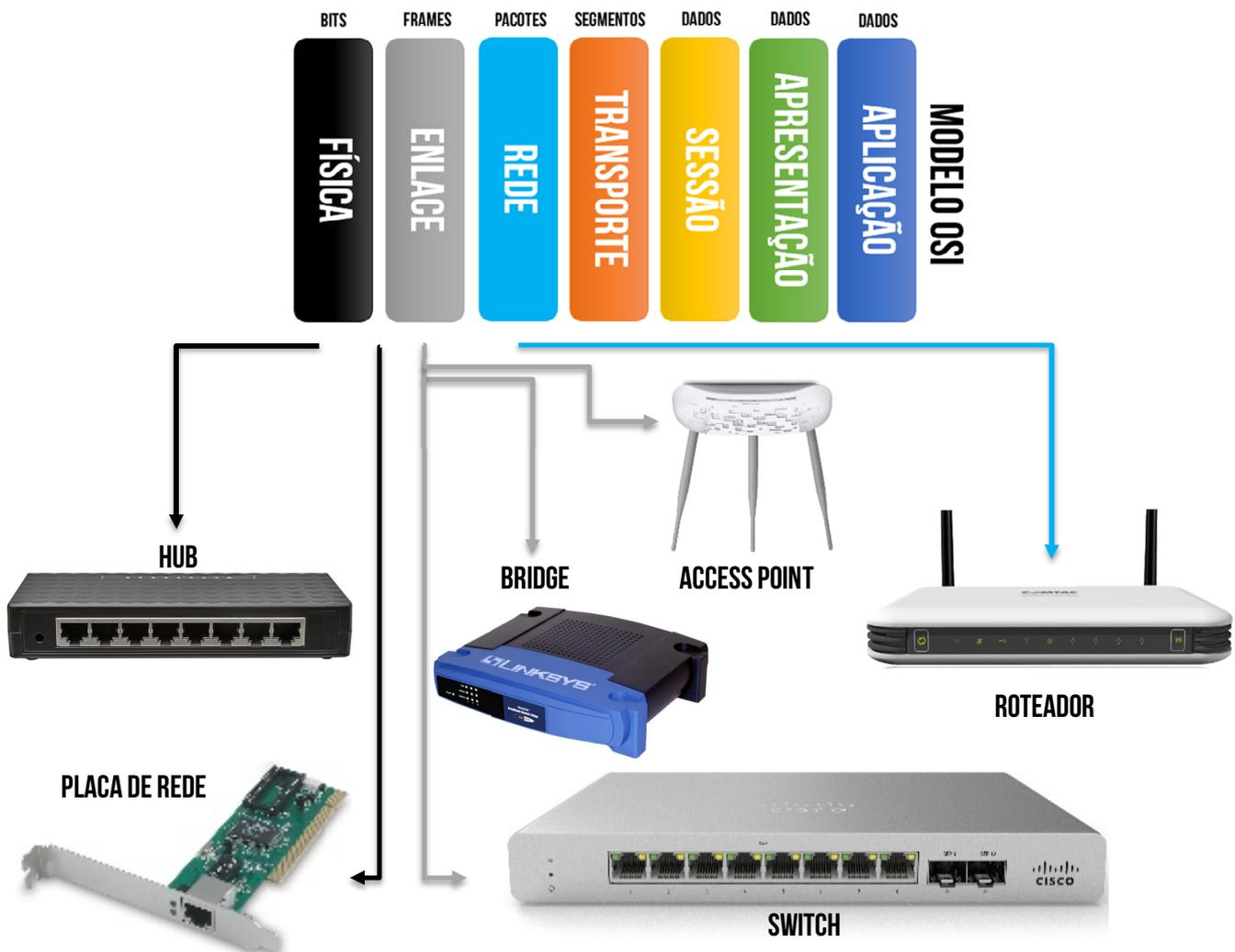
**(CESPE – PC/AL – Escrivão de Polícia)** O modelo OSI (*Open Systems Interconnection*), um conjunto de protocolos destinados ao projeto de sistemas de redes, possibilita a comunicação entre todos os tipos de sistemas de computadores.
