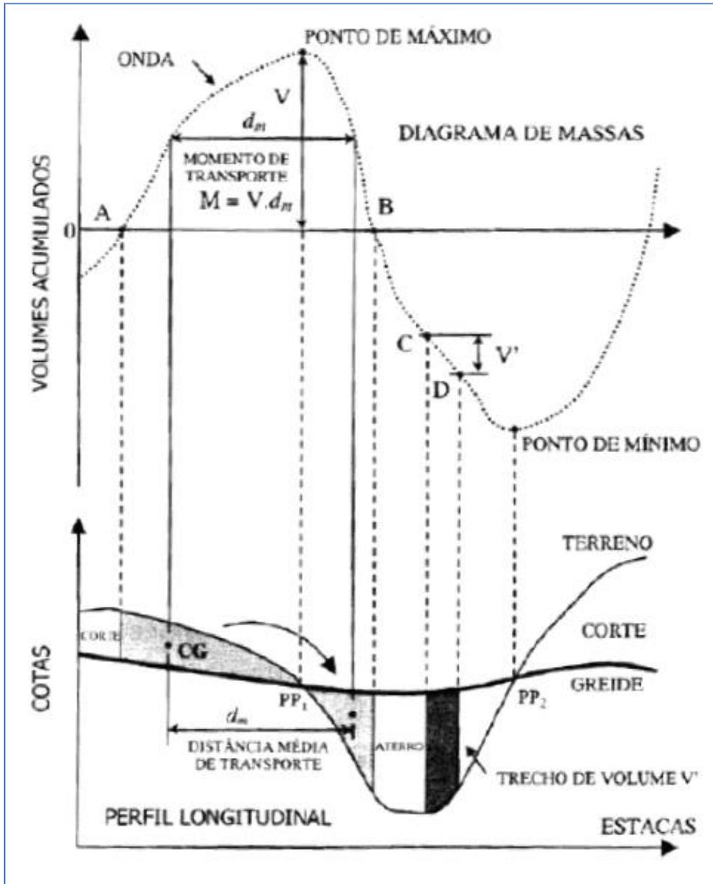
Vale destacar que o diagrama de massas não é um perfil, ou seja, a forma do diagrama de massas não guarda relação direta com a topografia do terreno.
