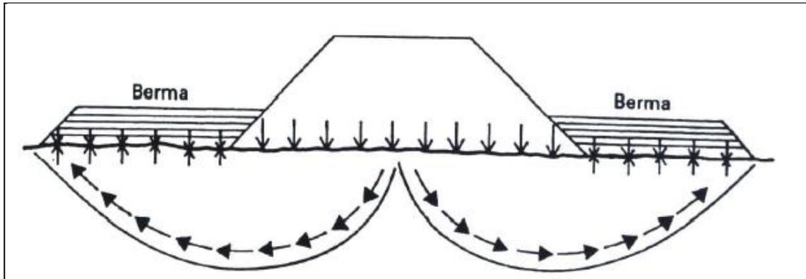
No desenho acima estão representadas as superfícies de ruptura do aterro. O contrapeso das bermas evita o rompimento pelas superfícies indicadas, aumentando a estabilidade do aterro e, por consequência, a altura admissível do aterro.
