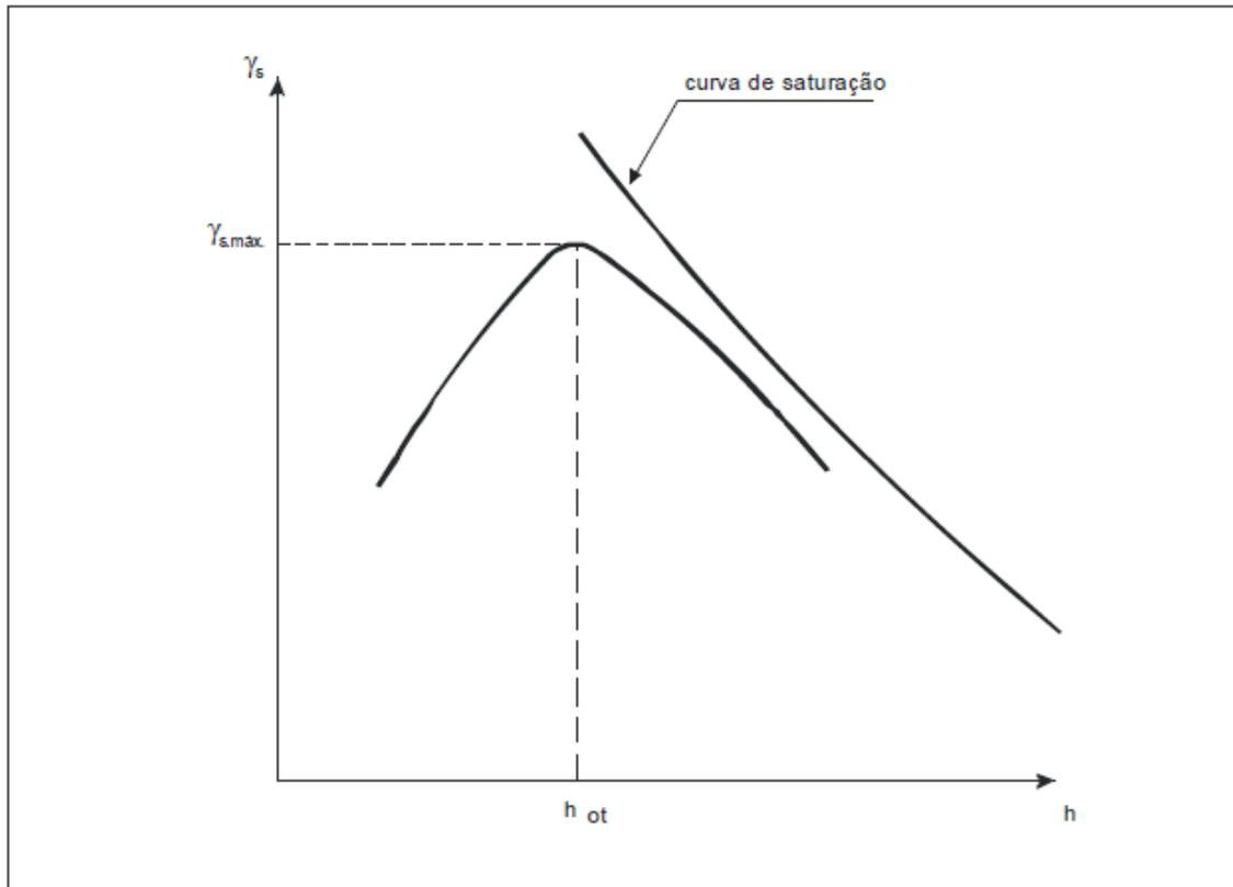
A partir deste ensaio, obtém-se a umidade ótima. Aplicando-se à camada de solo energia de compactação compatível com a aplicada no ensaio, com a umidade ótima, obtém-se o peso específico aparente seco máximo para esta energia.
