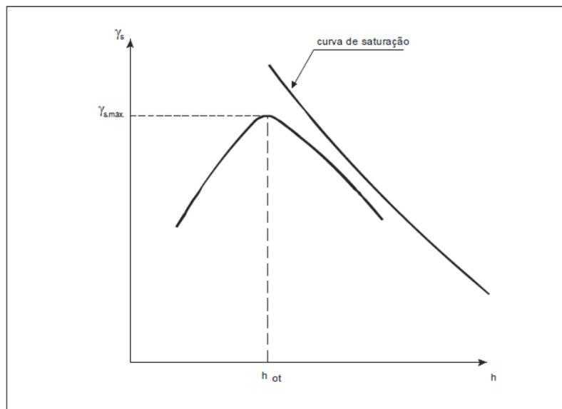
O teor de umidade que corresponde à máxima massa específica aparente seca corresponderá à umidade ótima -  $h_{ot}$ .
