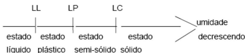
À medida que o solo perde água, ele passa do estado líquido para o estado plástico, para o estado semi-sólido até atingir o estado sólido, conforme a figura abaixo:
