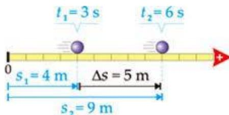
A posição final do corpo é  $S_F = 9\text{m}$  enquanto que a posição inicial é  $S_0 = 4\text{m}$ . Portanto, a variação da posição ou  $\Delta S = 9\text{m} - 4\text{m} = 5\text{m}$ .
