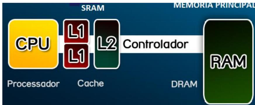
As **memórias SRAM** são designadas estáticas por serem constituídas de componentes designados flip-flop construídos com transistores, que mantêm armazenado o valor escrito até que receba um “reset” ou até que perca a energia (quando a alimentação é desligada).
