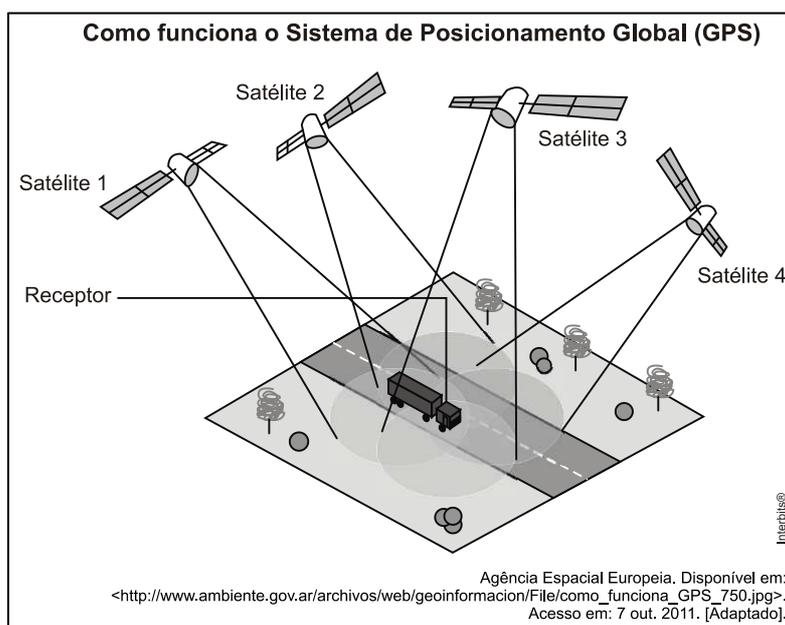
Atualmente existem três categorias de equipamentos GPS em uso: o recreacional (ou navegador), o topográfico e o geodésico. Para os dois últimos, é necessário processar as informações antes de usá-las.
