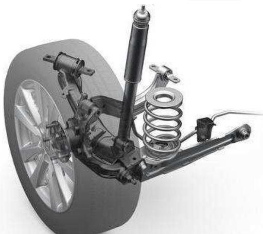
Estes estão separados e existe muita liberdade, no que diz respeito ao posicionamento. O maior número de braços permite-lhe lidar com movimento em muitas direções e mantém as rodas em contato com a superfície da estrada a todo o momento. **Este tipo de suspensão é usado com frequência na suspensão traseira de carros de tração dianteira de alto desempenho para manter a estabilidade e a alta velocidade, e em carros de tração traseira com muita potência para manter tração.**
