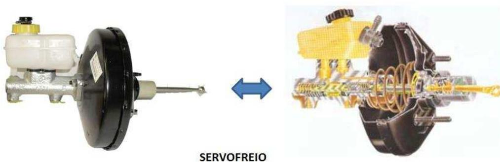
Num sistema simples, o motor aspira ar de ambos os lados de um diafragma (ou do pistão principal), o qual é mantido em estado de equilíbrio até ser aplicado o pedal de freio. Em consequência, a pressão atmosférica é admitida de um dos lados, enquanto no outro permanece um vácuo parcial, pelo que o diafragma se move exercendo pressão sobre um pistão servo. Essa pressão reforça a força aplicada pelo motorista!
