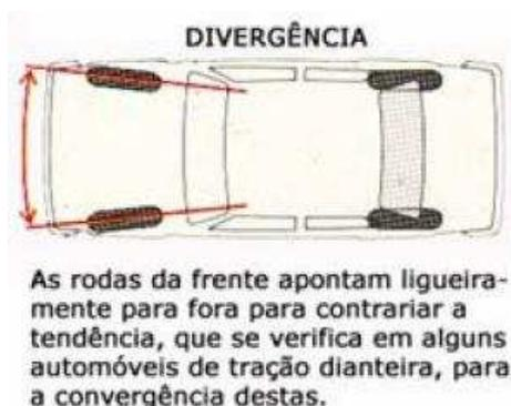
Para compensar a tendência de abertura das rodas, devido à resistência ao rolamento dos pneus e às folgas do sistema de direção, ou fechamento devido à força motriz, é recomendado para cada
