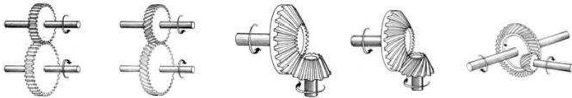
As engrenagens, estas maravilhas mecânicas, executam tarefas com extrema precisão, hora alterando a força, hora alterando a velocidade. Para facilitar a compreensão, utilizaremos o exemplo da bicicleta, que transporta uma pessoa com velocidade maior do que seria conseguida com suas pernas. Isso acontece porque a corrente e as marchas fazem girar a roda traseira mais depressa do que o movimento dos pedais.
