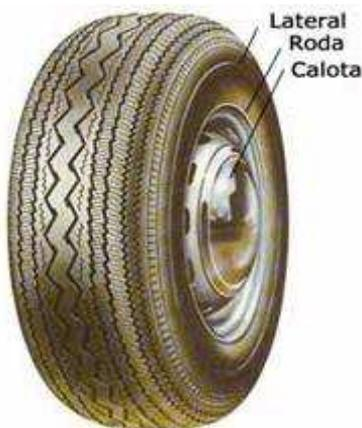
Possui uma carcaça interior resistente, com cabos metálicos (talões) incorporados na zona de contato com a roda e paredes laterais flexíveis, destinadas a absorver as cargas que lhes são impostas. As ranhuras da banda de rodagem, ou rasto, facilitam a aderência ao solo em variadas condições de rolamento.
