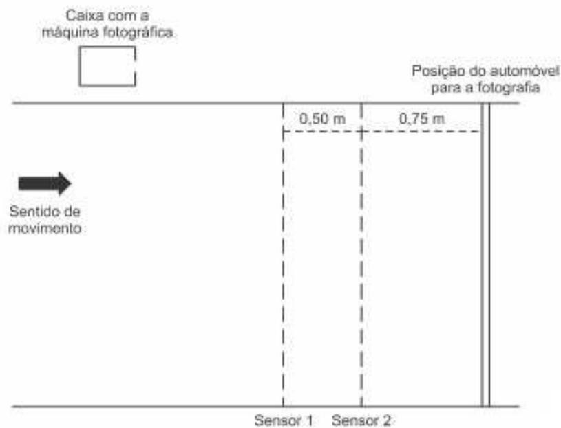
**11.1.** No caso de um automóvel que trafega na velocidade máxima permitida, o tempo, em milissegundos, medido pelo dispositivo, é superior a 20 milissegundos.
