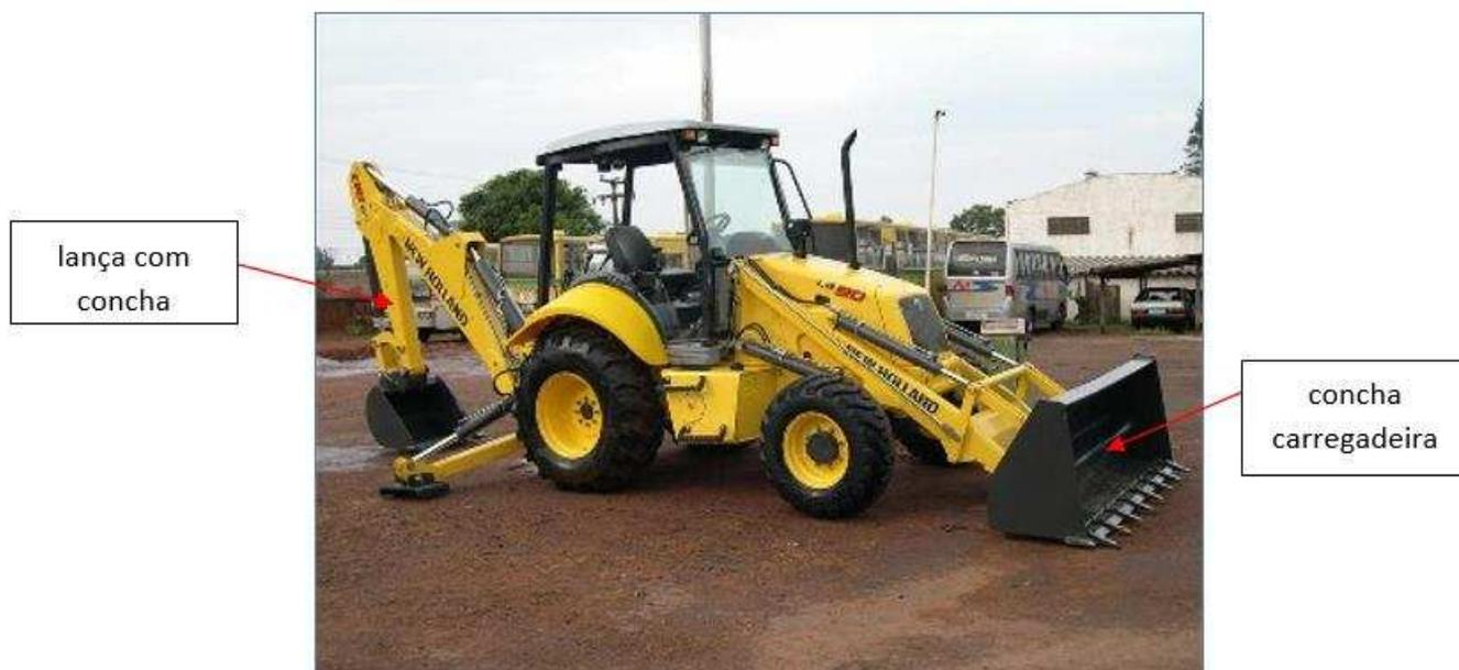
Em obras rodoviárias, esse equipamento é bastante utilizado na escavação de valas para a implantação de drenos profundos, sendo pouco utilizado nas operações de terraplenagem propriamente ditas.
