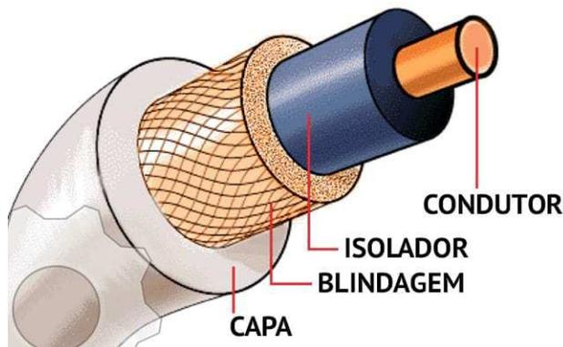
**Consiste em um fio central de cobre, envolvido por uma blindagem metálica.** Isolantes de plástico flexível separam os condutores internos e externos e outras camadas do revestimento que cobrem a malha externa. Esse meio de transmissão é mais barato, relativamente flexível e muito resistente à interferência eletromagnéticas graças à malha de proteção que possui. Esse cabo cobre distâncias maiores que o cabo de par trançado e utiliza um conector chamado BNC.
