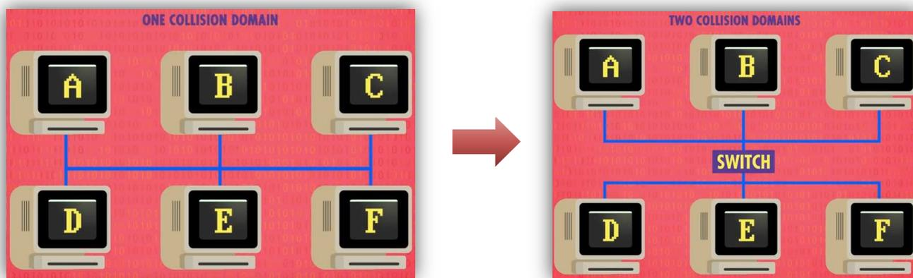
**Para tal, podemos utilizar um dispositivo chamado Switch – visto anteriormente. Ele dividirá nossa rede em duas partes e será posicionado entre elas.** Dessa forma, ele só passa dados para o outro domínio de colisão se a mensagem for destinada a algum computador presente nesse domínio de colisão. *Como ele faz isso, professor?* Ele guarda uma lista de Endereços MAC dos computadores de cada rede.
