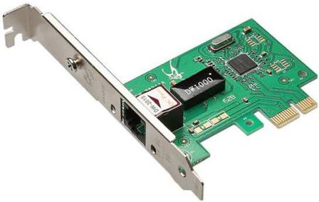
**Galera, essa é a famosa Placa de Rede!** Se vocês olharem na parte de trás do gabinete de um computador, vocês a verão (provavelmente com o cabo de par trançado azul conectado a ela). Ela é o recurso de hardware mínimo que deverá estar instalado no computador para permitir a comunicação (transmissão e recebimento de dados) com os demais elementos da rede. Agora vejam que coisa interessante...
