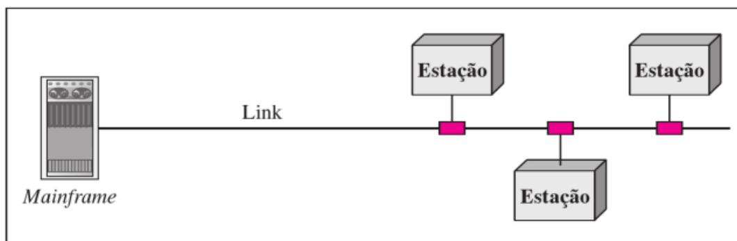
**Já em uma conexão ponto-multiponto, mais de dois dispositivos compartilham um único link.** Em um ambiente multiponto, a capacidade do canal de comunicação é compartilhada, seja de forma espacial, seja de forma temporal. Se diversos dispositivos puderem usar o link simultaneamente, ele é chamado de conexão compartilhada no espaço. Se os usuários tiverem de se revezar entre si, trata-se de uma conexão compartilhada no tempo - esse é o modo padrão.
