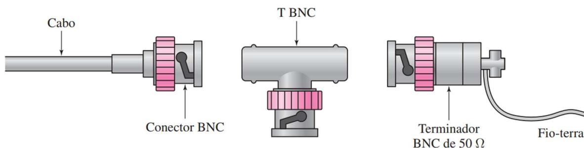
Foi utilizado até meados da década de 90 em redes de computadores, quando começou a ser substituído pelo cabo de par trançado. Ele ainda é utilizado em telecomunicações, basta dar uma olhadinha no decodificador da sua TV por Assinatura. **O cabo que chega na sua casa/prédio e que entra em um modem é geralmente um cabo coaxial** – ele é capaz de transportar sinais de Internet e TV.
