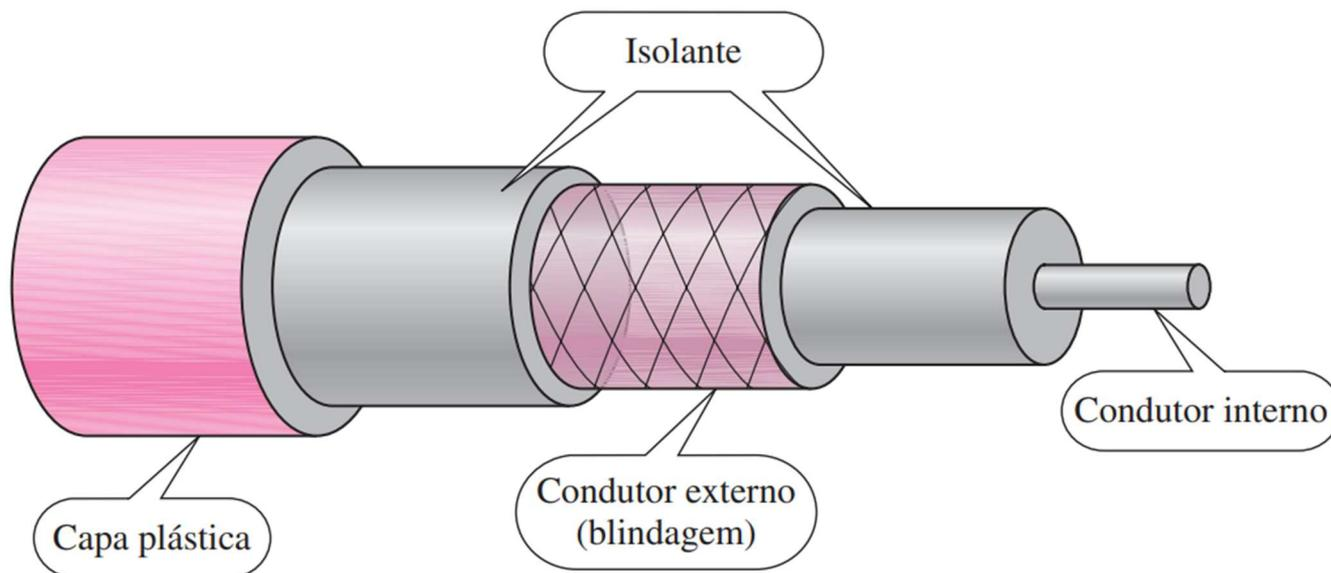
Consiste em um fio central de cobre, envolvido por uma blindagem metálica. Isolantes de plástico flexível separam os condutores internos e externos e outras camadas do revestimento que cobrem a malha externa. Esse meio de transmissão é mais barato, pouco flexível e muito resistente à interferência eletromagnética graças a sua malha de proteção. Ele cobre distâncias maiores que o cabo de par trançado e utiliza um conector chamado BNC<sup>8</sup>.
