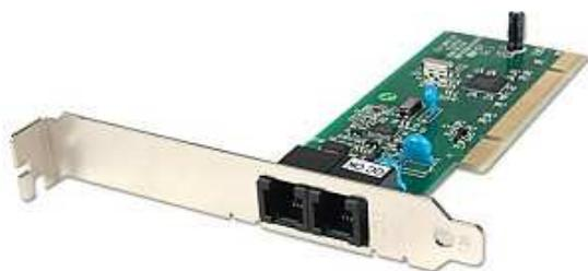
O Modem é um dispositivo eletrônico de entrada/saída de dados que modula um sinal digital em um sinal analógico a ser transmitido por meio de uma linha telefônica e que demodula o sinal analógico e o converte para o sinal digital original. **Hoje em dia, existem basicamente três tipos: Acesso Discado, Modem ADSL e Cable Modem.**
