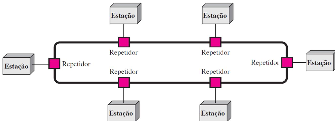
Imagine que um dispositivo deseje enviar mensagem para outro dispositivo do anel. Ele enviará para o dispositivo ao lado; ele verificará que não é o destinatário da mensagem e repetirá a mensagem para seu dispositivo ao lado (**por isso os repetidores**); o próximo dispositivo fará o mesmo procedimento até chegar ao dispositivo de destino, que receberá os dados e enviará uma mensagem para o dispositivo remetente original para informá-lo de que recebeu os dados.
