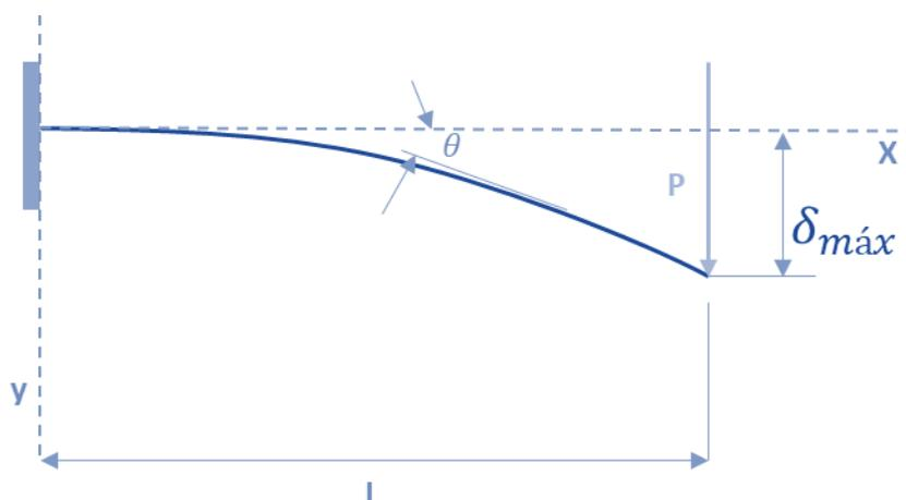
A obtenção das **equações para deflexão** em vigas é realizada através da **integração de equações diferenciais** que descrevem a curva da linha elástica da viga. Quando abordamos vigas com pequenos
