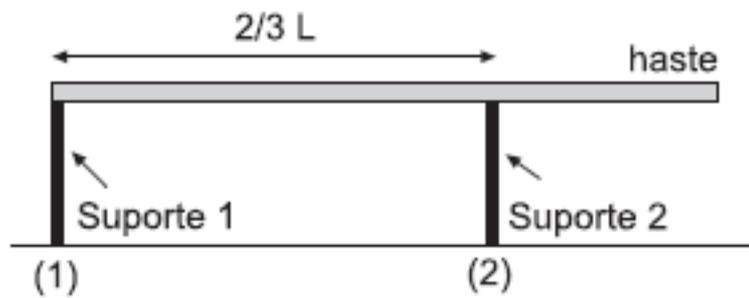
Uma haste homogênea de massa  $50,0 \text{ kg}$  é colocada horizontalmente sobre dois suportes, conforme mostra a figura.
