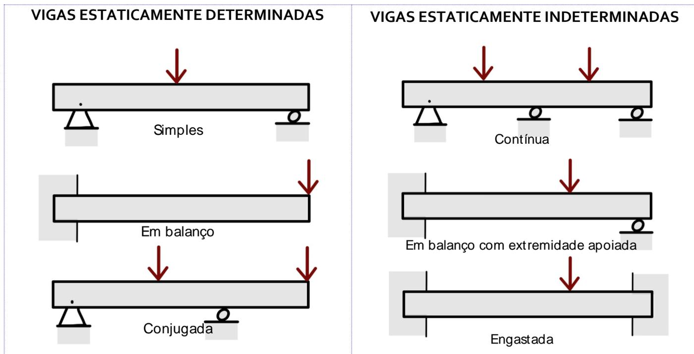
Podemos também identificar as vigas pelos **tipos de carregamentos externos** qual estão expostas. Estas podem sofrer cargas concentradas, como vistas na figura acima ou distribuídas, conforme a figura abaixo.
