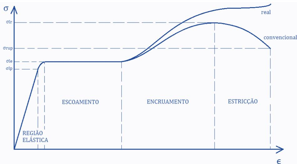
Quando são calculados os valores de tensão e deformação a partir da área da seção transversal e o comprimento do corpo de prova no instante em que a carga é medida, obtemos a curva tensão X deformação real exemplificada na figura acima. Apesar de o diagrama de tensão-deformação convencional e real serem diferentes, a maioria dos estudos e projetos são voltados para dentro da região elástica do material.
