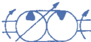
A sua descrição é: Conversor de torque. Bomba e/ou motor de deslocamento variável.
