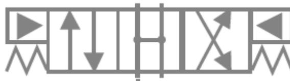
Válvula operada hidraulicamente, com retorno por mola para a posição central
