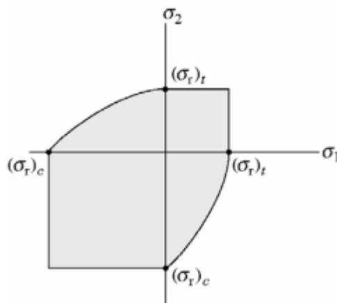
Cabe destacar que, devido a existirem imperfeições em materiais frágeis, é difícil de prever a ruptura sob tensão desse tipo de material, por isso **teorias de falhas para materiais frágeis** devem ser utilizadas com **cautela**.
