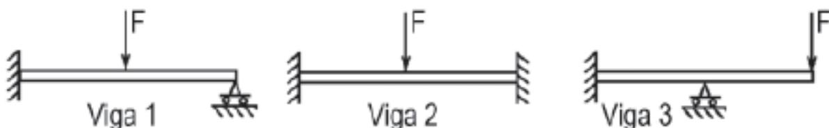
Ao retirar-se uma das restrições de apoio de cada uma dessas vigas, aquela(s) que se tornará(ão) estaticamente determinada(s) é(são), APENAS, a(s) viga(s)
