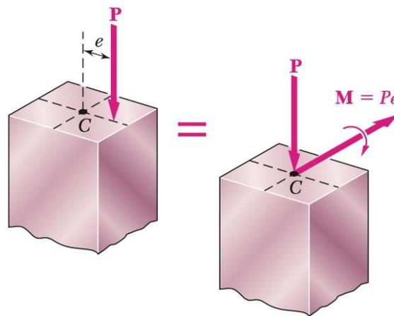
Para obter a tensão normal nesse caso, deve-se somar as tensões normais da carga centrada com as tensões de flexão geradas pelo momento, da seguinte forma.
