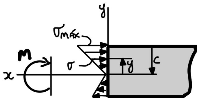
Analogamente para se determinar a tensão normal a uma distância intermediária ( $y$ ), podemos calcular está a partir da seguinte equação:
