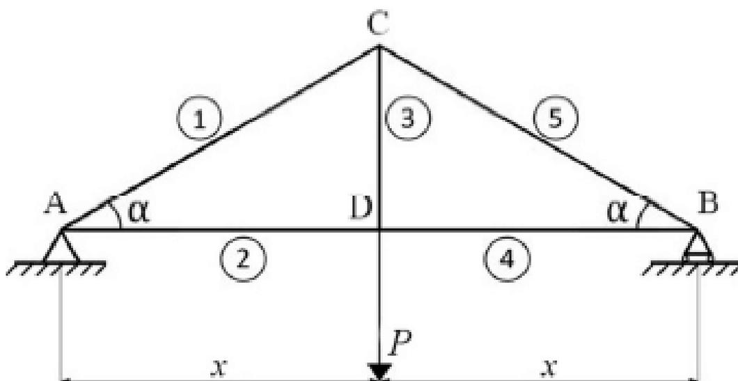
A figura precedente ilustra uma treliça, composta pelas barras retas numeradas de 1 a 5 e ligadas nos quatro nós A, B, C e D; em A, há um apoio fixo, e em B, há um apoio móvel. Na figura,  $P = 10$  kN,  $x = 10$  m e  $\alpha = 30^\circ$ .
