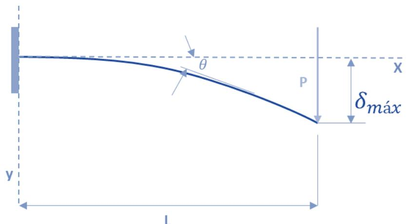
A obteno das **equaes para deflexo** em vigas  realizada atravs da **integrao de equaes diferenciais** que descrevem a curva da linha elstica da viga. Quando abordamos vigas com pequenos ngulos de rotao, que so aquelas encontradas em edifcios, automveis, aeronaves... a curva de deflexo  muito pequena e assim sua **curvatura (k)** pode ser dada por:
