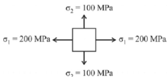
Um componente estrutural fabricado em aço dúctil está submetido a um estado plano de tensões, representado, em determinado ponto, pelo elemento de tensões mostrado na figura acima, em que  $\sigma_1 = 200$  MPa e  $\sigma_2 = 100$  MPa. Considerando a possibilidade de falha por escoamento, julgue o item abaixo, a respeito da resistência ao escoamento do material do referido componente.
