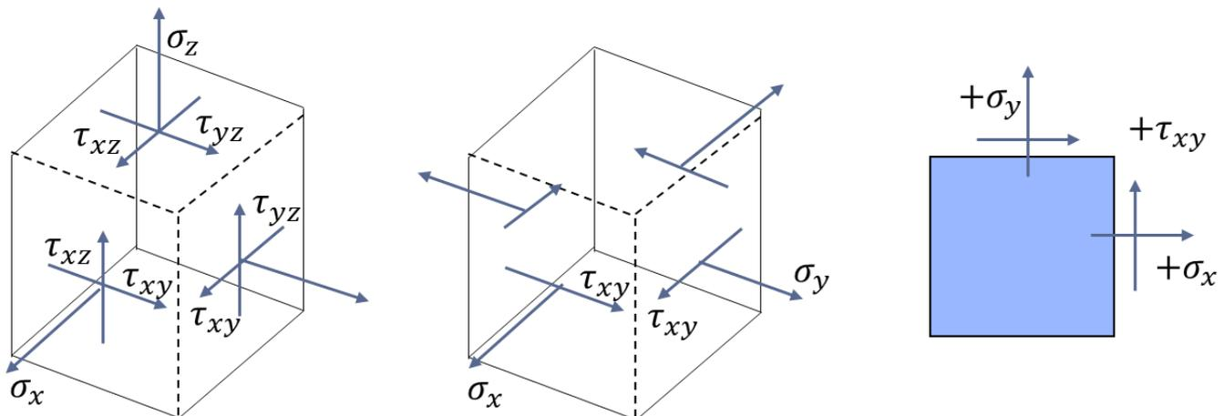
Visto isso, podemos afirmar que **se um estado de tensão em um ponto for conhecido**, de acordo com uma orientação determinada de um elemento do material, **podemos então determinar o estado de tensão para uma orientação diferente** através das seguintes equações:
