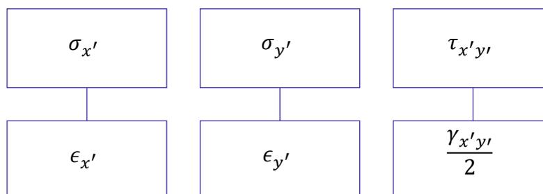
Devido à similaridade entre as tensões e deformações no plano, podemos determinar a **direção do eixo e as deformações principais** ( $\epsilon_1$  e  $\epsilon_2$ ) pelas seguintes expressões:
