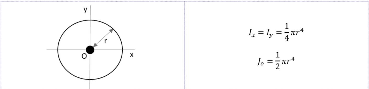
Se o momento de inércia de uma área situada em torno de um eixo centroidal for conhecido, é possível determinar o momento de inércia da área em torno de um **eixo paralelo** correspondente através do **TEOREMA DOS EIXOS PARALELOS**. Esse teorema é muito utilizado na hora de calcularmos o momento de inércia de **áreas compostas**. As equações que definem o teorema dos eixos paralelos são:
