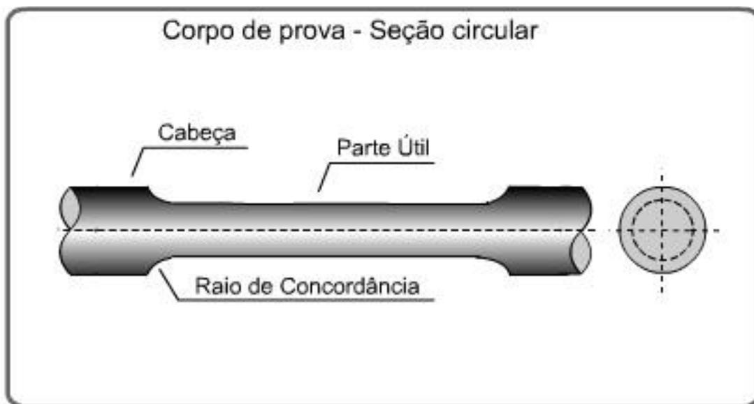
A Parte útil é a porção efetivamente utilizada para medição do alongamento.
