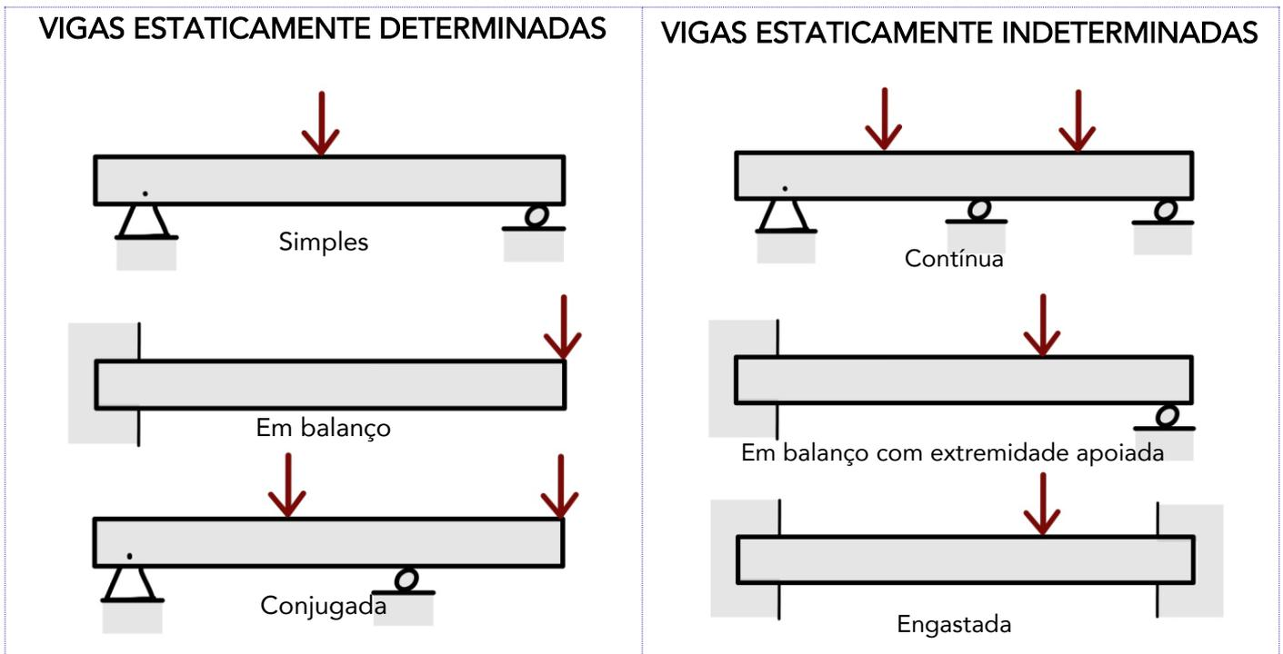
Basicamente, as vigas que se encontram apoiadas, de maneira que podemos calcular as reações aos seus apoios externos aplicando somente os métodos da estática (equações de equilíbrio), são chamadas de vigas estaticamente determinadas. Vigas que possuem mais pontos de apoios do que o necessário para que estejam em equilíbrio, são denominadas estaticamente indeterminadas (possuem maior número de reações de apoios do que equações de equilíbrio).
