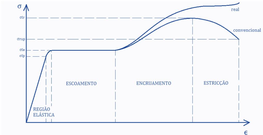
Quando são calculados os valores de tensão e deformação a partir da área da seção transversal e o comprimento do corpo de prova no instante em que a carga é medida, obtemos a curva tensão X deformação real exemplificada na figura acima. Apesar de o diagrama de tensão-deformação convencional e real serem diferentes, a maioria dos estudos e projetos são voltados para dentro da região elástica do material.
