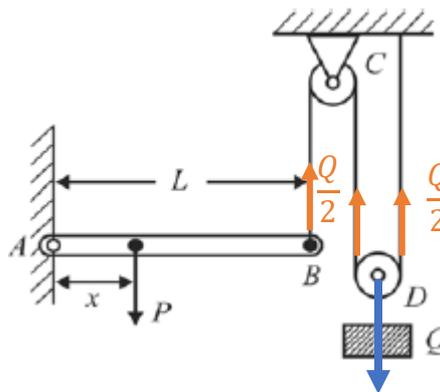
Após o DCL, podemos aplicar o somatório de momentos em relação ao ponto A na viga AB, sendo esse igual a zero para que ela permaneça na horizontal e assim encontramos a expressão para determinação de x.
