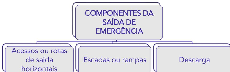
Se a banca te perguntar quais são os componentes da saída de emergência, lembre-se de um trajeto de saída de um edifício: Se você está no quinto andar, por exemplo, você sai de uma sala e pega um corredor (**acesso, rota de saída horizontal**) até uma **escada ou rampa**, desce e chega na área de **descarga** (que dá acesso à área externa da edificação).
