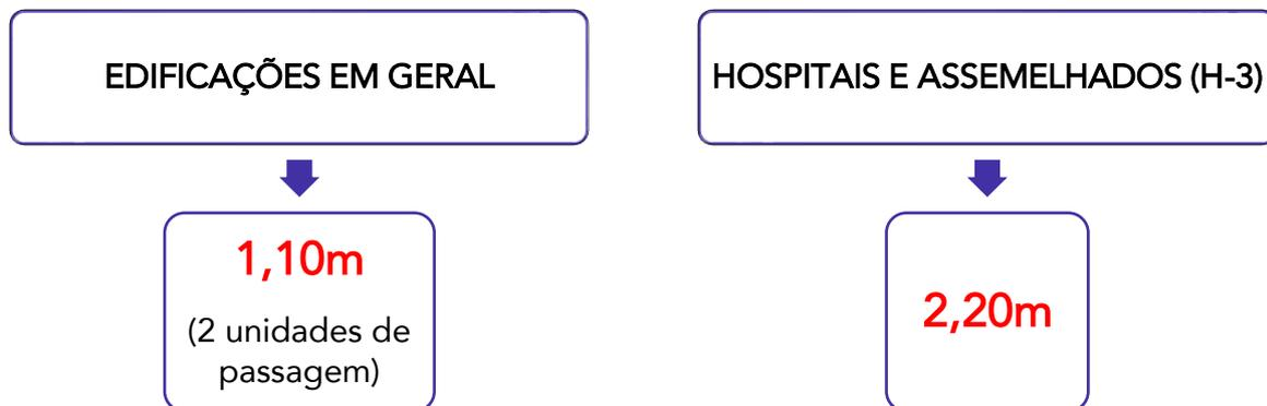
→ A largura da saída deve ser medida em sua **parte mais estreita**, não sendo admitidas saliências de alizares, pilares, e outros, com dimensões maiores que as indicadas na figura (**máximo 25cm de largura e máximo 10cm de profundidade**), desde que a **saída possua largura superior a 1,10m**. Essa situação está exemplificada no lado direito da figura acima.
