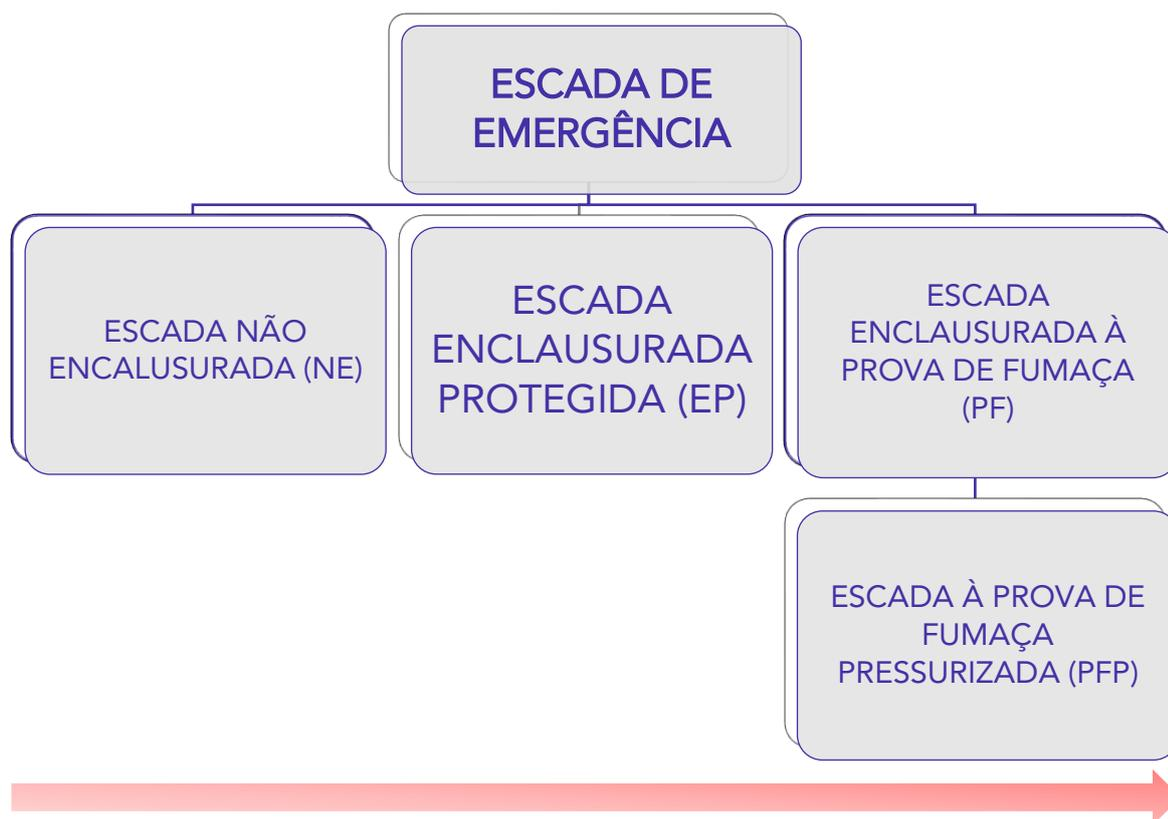
→ A escada "**NE**" é uma escada comum da edificação, mas que pode servir como rota de saída de emergência. Ela é o **tipo mais simples** de escada de emergência.
