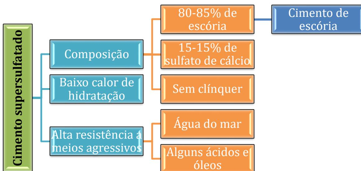
Figura 15: esquema do cimento supersulfatado
