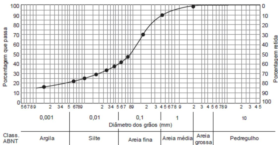
**Figura 19: curva granulométrica, relacionando quantidades no eixo vertical e diâmetro das partículas no horizontal (FCC, 2013)**
