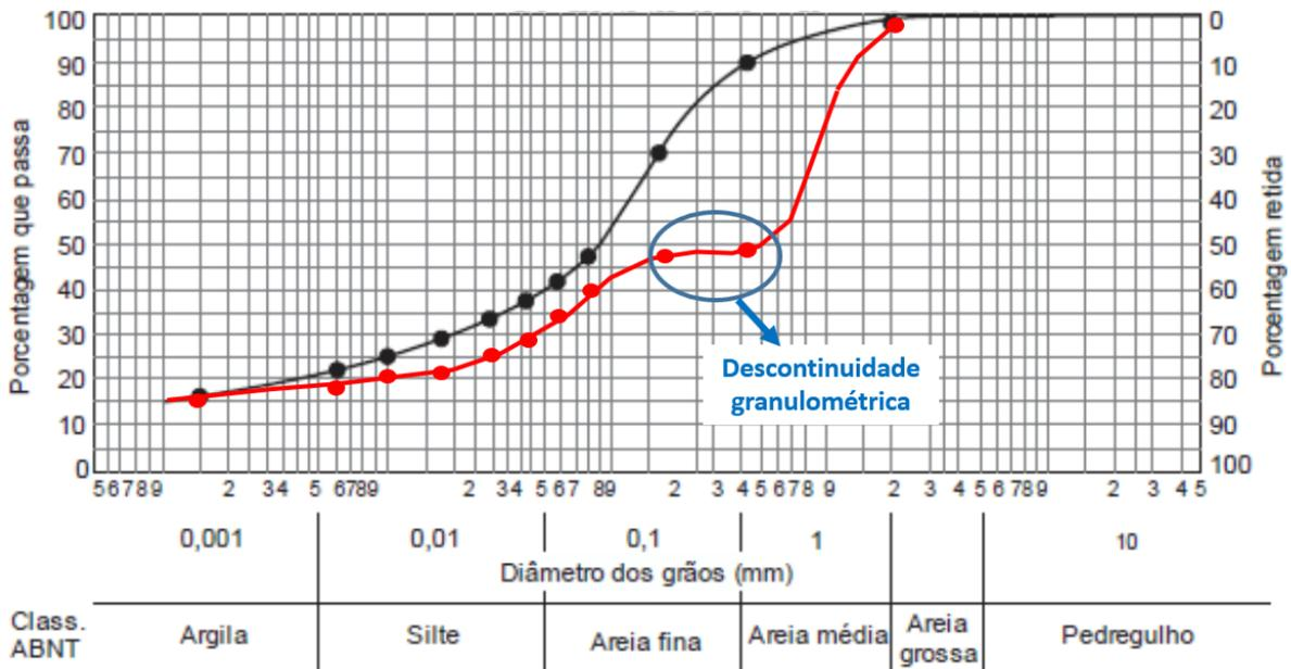
**Figura 22: curva granulométrica contínua (em preto) e descontínua (em vermelho). A curva descontínua tem muito mais probabilidade de resultar em um concreto que sofra facilmente segregação (FCC, 2013, adaptado)**
