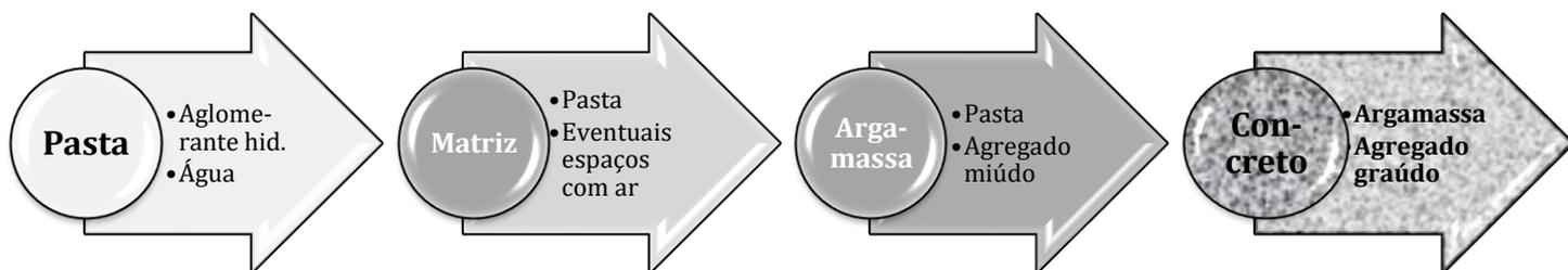
Figura 4: composição da pasta, argamassa e concreto
