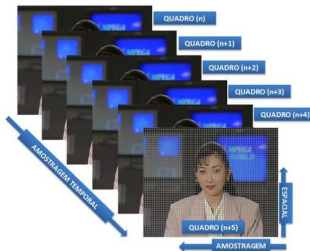
Figura 3.1: Elementos de uma sequência de vídeo digital
