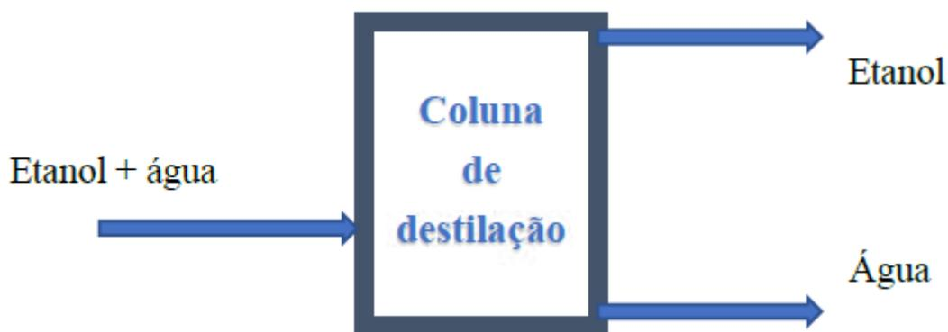
O objetivo deste processo é separar o etanol e a água, observe que alimentamos uma mistura das duas substâncias e temos duas correntes de saídas com nossos produtos refinados.
